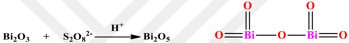
Şekil 3.5. Bizmut (V) oksidin oluşum reaksiyonu ve molekül yapısı
