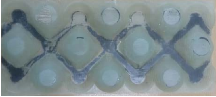
Şekil 4.13. Federli Dairesel çekirdekte eğilme testi sonrası oluşan hasar
