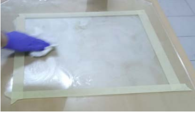
Şekil 2.5 Cam yüzeyine vaks sürülmesi
