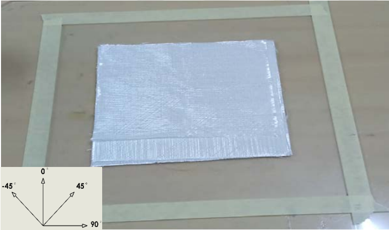
Şekil 2.6. Cam elyaf dizilimi
