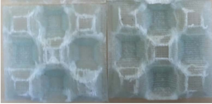
Şekil 4.21. Piramit yapılı çekirdek basma testi sonrası görünüm
