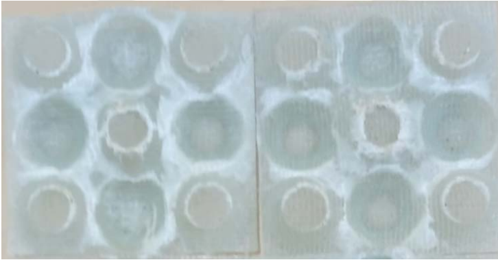
Şekil 4.22. Konik yapılı çekirdek basma testi sonrası görünüm
