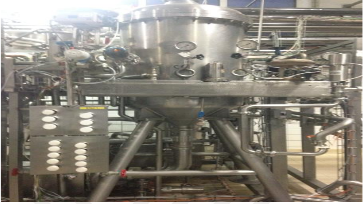
Şekil 3.7. UHT hattı sterilize edilen ürünün soğutulmasında kullanılan flaş tankı
