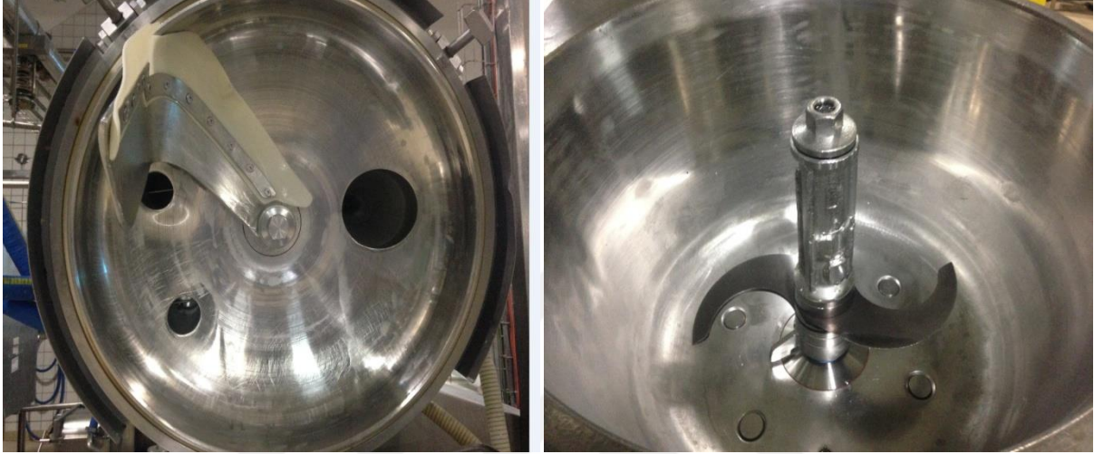
Şekil 3.3. Pişirme kazanı üst katıştırıcısı(solda) ve kazan alt bıçakları(sağda)
