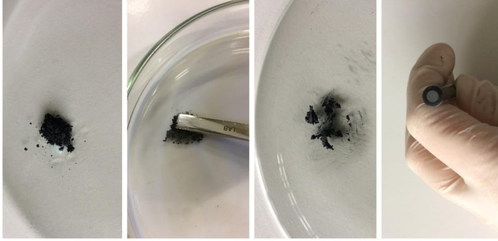
Şekil 3.2. Al 2 O 3 NP-KPE hazırlama aşamaları
