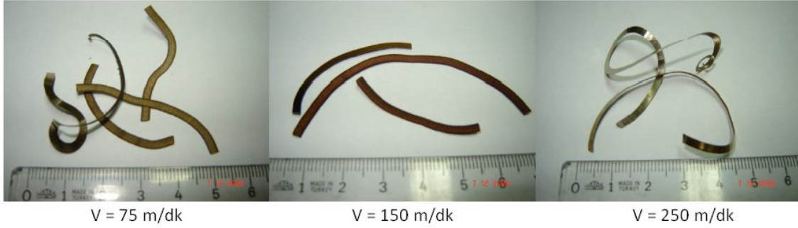
Resim 6.6 Kesme hızının talaş şekli üzerindeki etkisi ( f= 0,1\text{ mm/dev} , Kaplamasız).
