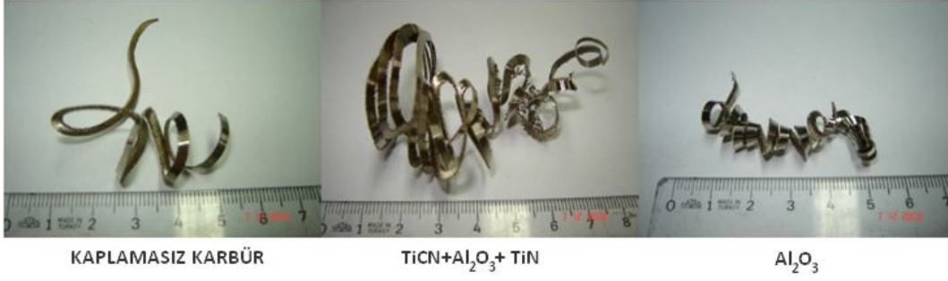
Resim 6.2 Kaplamanın talaş şekli üzerindeki etkisi ( V= 250\text{m/dak} , f=0,3 \text{ mm/dev} ).
