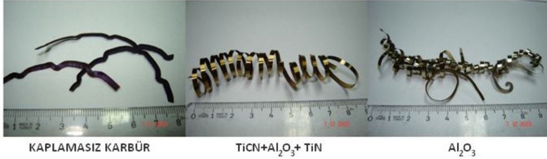
Resim 6.1 Kaplamanın talaş şekli üzerindeki etkisi (V= 75m/dak, f=0,05 mm/dev).
