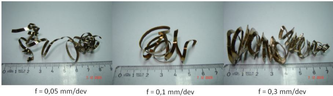
Resim 6.4 İlerlemenin talaş şekli üzerindeki etkisi ( V= 150\text{m/dak} , \text{TiCN}+\text{Al}_2\text{O}_3+\text{TiN} ).
