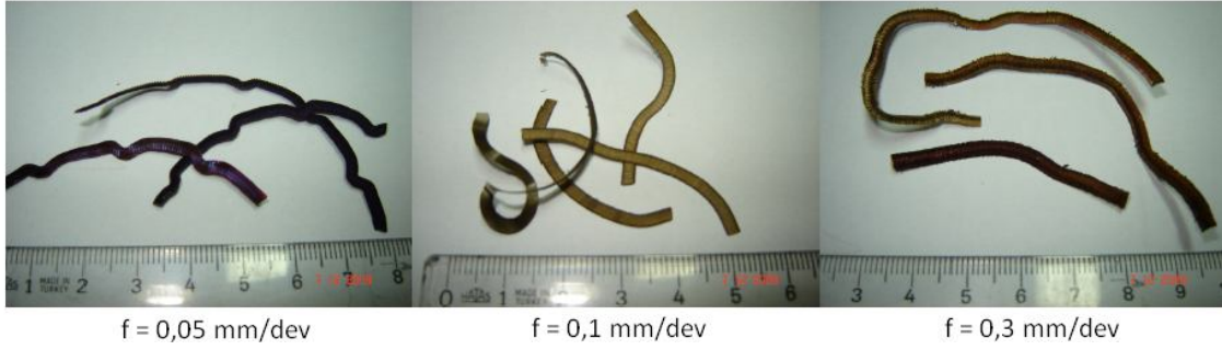
Resim 6.5 İlerlemenin talaş şekli üzerindeki etkisi ( V= 75\text{m/dak} , Kaplamasız).
