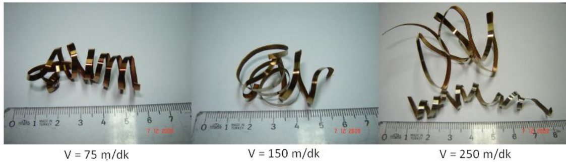
Resim 6.7 Kesme hızının talaş şekli üzerindeki etkisi ( f= 0,05\text{ mm/dev} , \text{TiCN}+\text{Al}_2\text{O}_3+\text{TiN} ).
