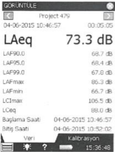
Şekil 9.9. Gündüz zaman diliminde 2. Nuktada yapılan ölçüm sonucu
