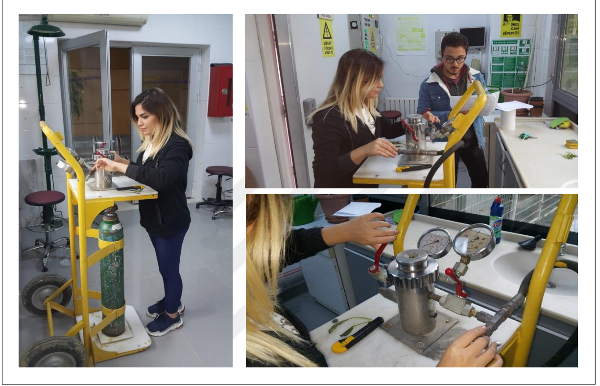
Şekil 3.10. Saf Azot (N) gazı kullanarak 40 atm (-4 MPa) basınca kadar ölçüm yapmakta olan Scholander basınç odası ile yaprak su potansiyeli ölçümleri
