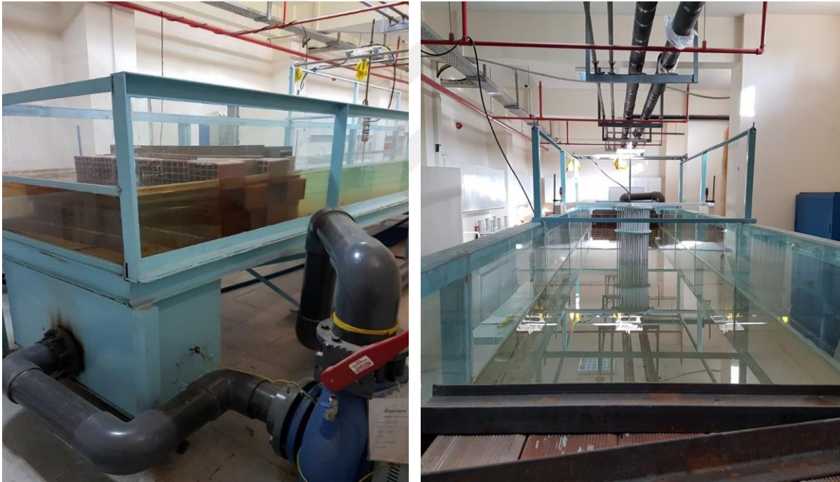
Şekil 5.1. Açık kanal laboratuvar düzeneği.
