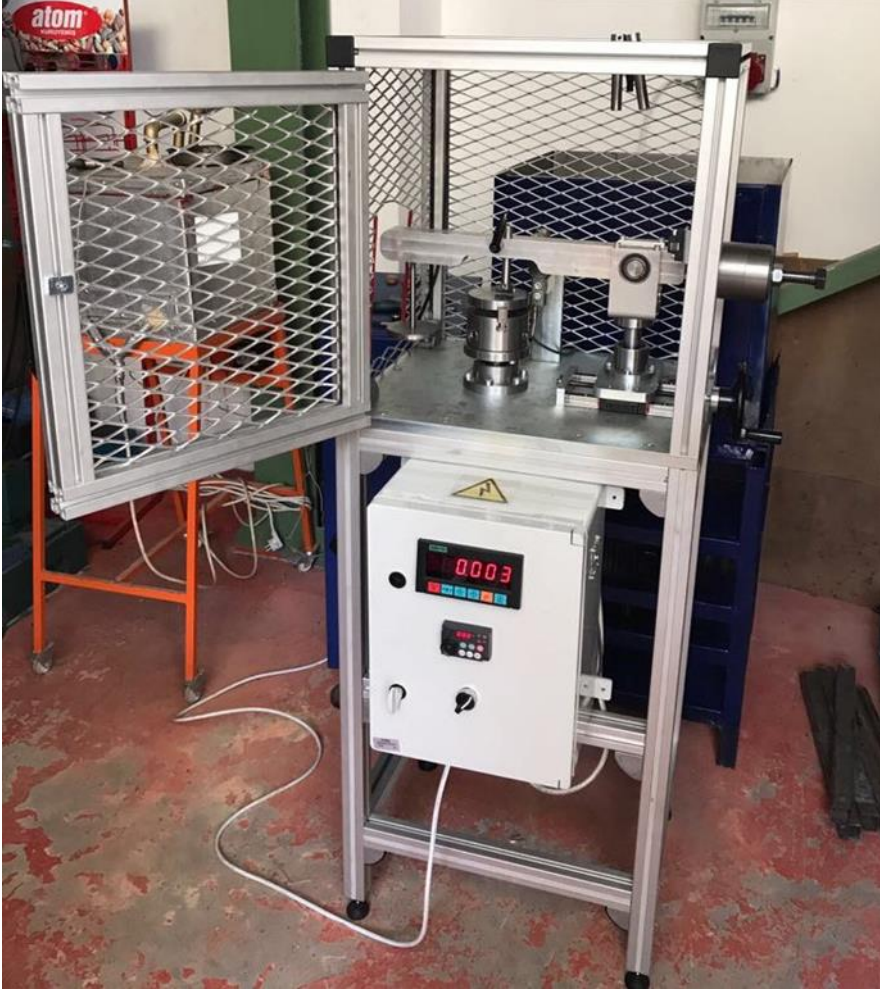
Şekil 3.1. Tasarımı ve imalatı gerçekleştirilen adhezif aşınma test cihazı
