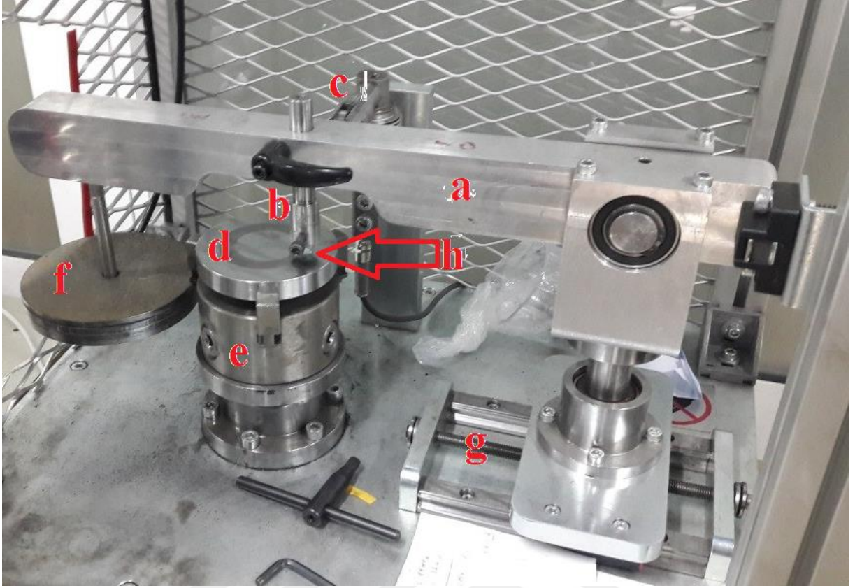
Şekil 3.3. Adhezif aşınma makinesi mekanik elemanları (a.Tutucu kolu b.Numune tutucu, c.Yük hücresi, d.Aşındırıcı disk, e.Ayna, f.Deney ağırlığı, g.Lineer kızak ve raylar, h.Numune)
