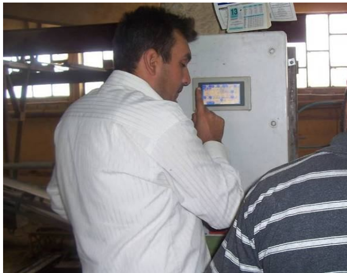
Resim 3.16 Beton travers karışımına giren malzemelerin ağırlıklarının ayarlanması
