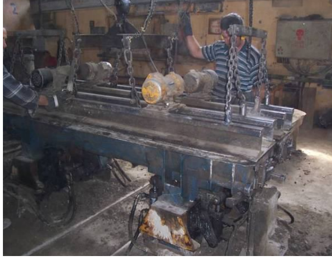
Resim 3.21 Beton traversin sıkıştırma kirişi ile birlikte titreşime tabi tutulması
