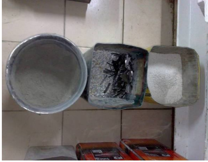
Resim 3.13 Beton karışımına giren malzemelerin ağırlık esasına gre hazırlanması
