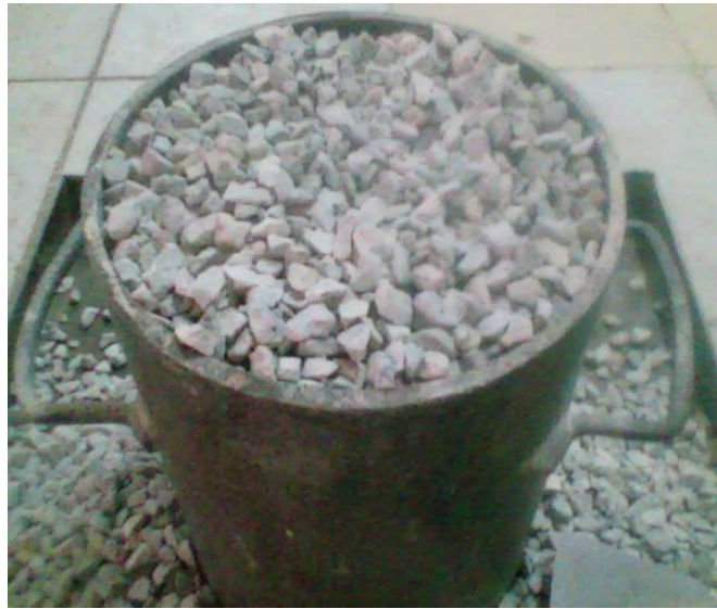
Resim 3.8 Agregalarda birim hacim ağırlık deneyinin yapılması
