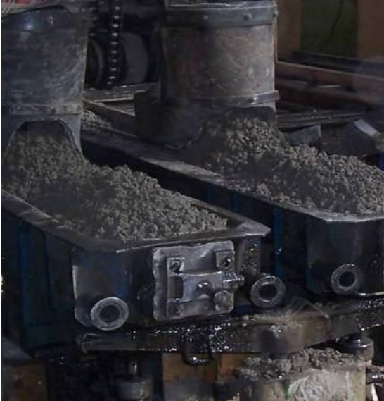
Resim 3.20 Kalıbın titreşime tabi tutularak doldurulması
