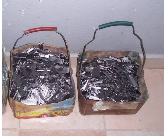
Resim 3.3 RC 80/60 BN tipi iki ucu kancalı çelik lif
