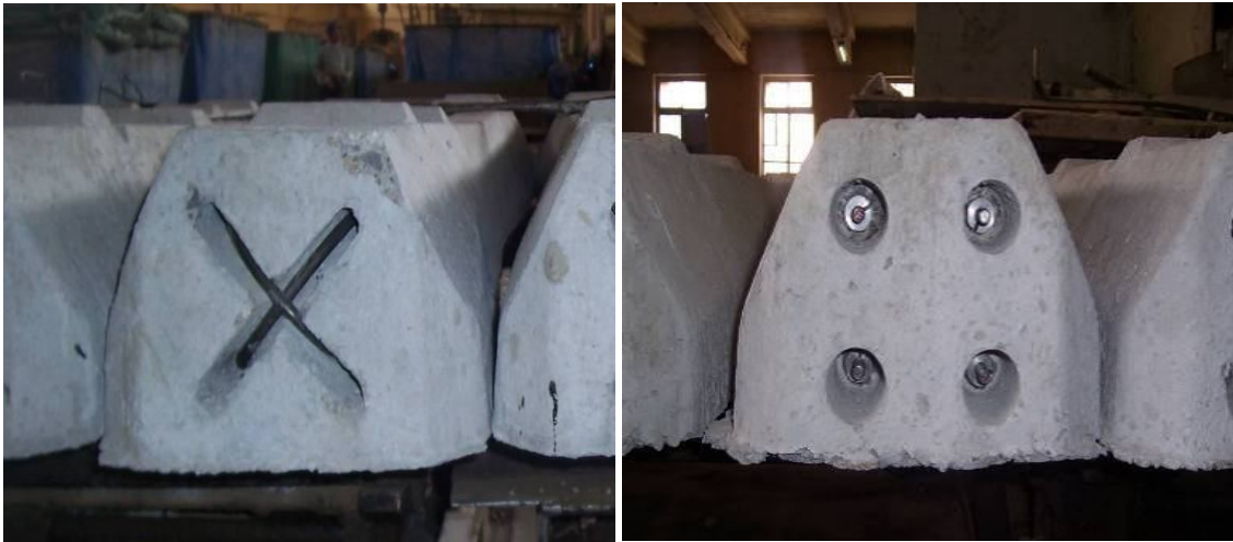
Resim 3.27 Beton travers numunelere gergi çeliklerinin takılması
