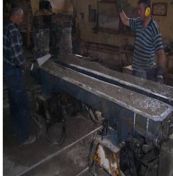
Resim 3.20 Kalıbın titreşime tabi tutularak doldurulması
