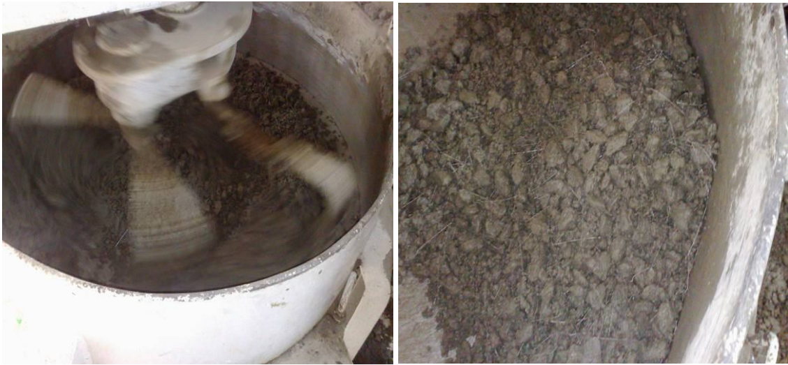
Resim 3.14 Beton karışımının hazırlanması
