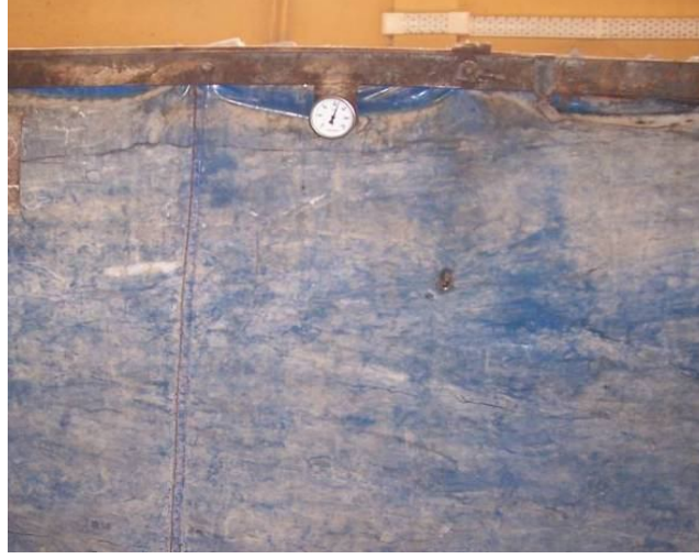
Resim 3.26 Üretilen numunelerin çadır içerisinde buhar kürüne tabi tutulması
