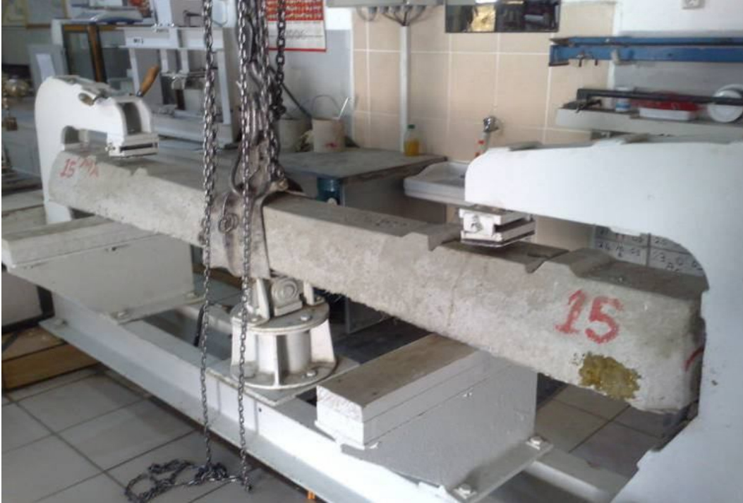
Resim 3.36. Beton traverslerin eğilme deneyi makinesine yerleştirilmesi
