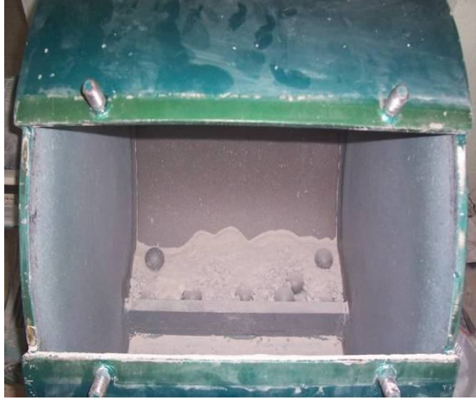
Resim 3.12 Agregalarda aşınmaya dayanıklılık deneyi yapılıması
