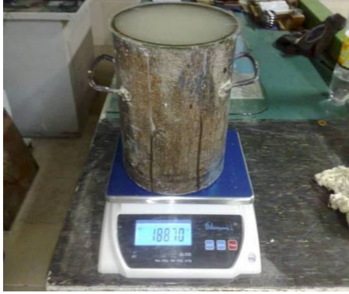
Resim 3.9 Agregalarda özgül ağırlık deneyinin yapılması
