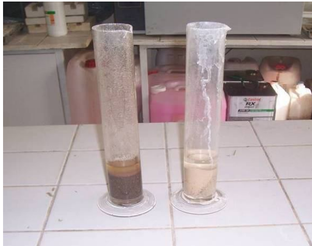
Resim 3.10 Agregalarda organik madde miktarı deneyi yapılması
