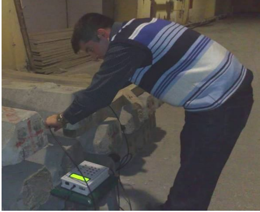
Resim 3.35 Ultrases hızı deneyi yapılması
