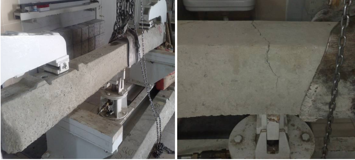
Resim 3.37 Eğilme deneyi yapılması
