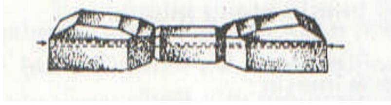
Resim 2.7 Üç bloklu beton travers (Anonim 2008)
