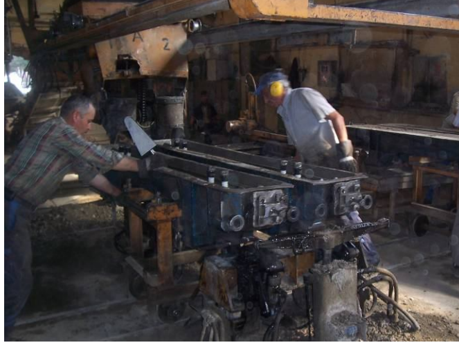
Resim 3.19 Üretime hazırlanmış travers kalıbının vibrasyon tezgahına getirilmesi
