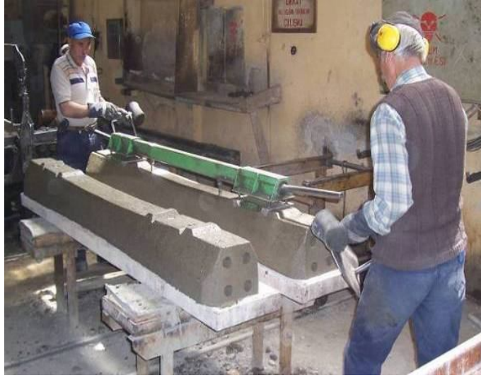
Resim 3.24 Beton traversin masterla kontrol edilmesi
