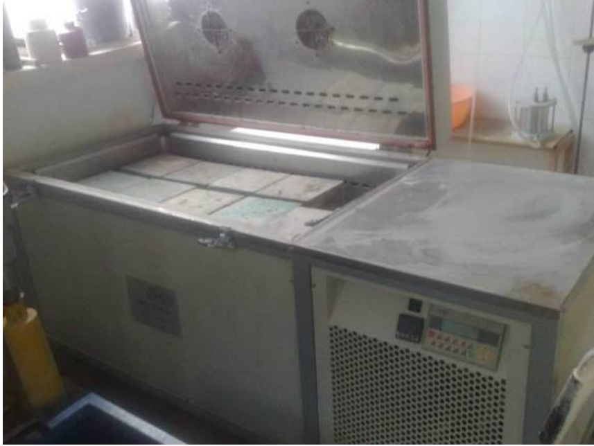
Resim 3.38 Donma çözünme deneyi yapılması
