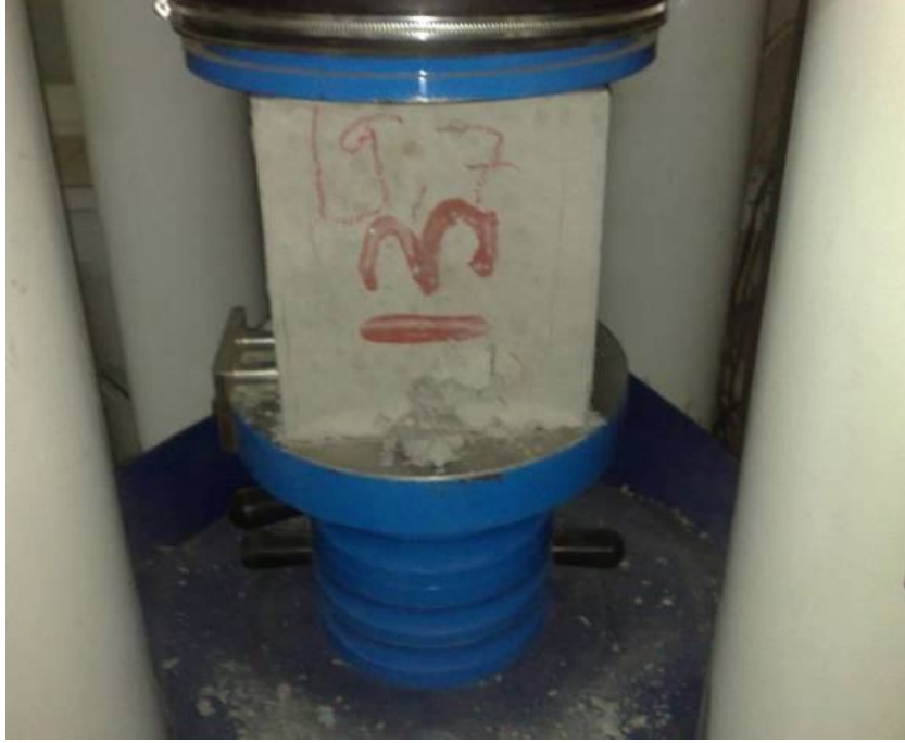
Resim 3.34 Basınç deneyi yapılması
