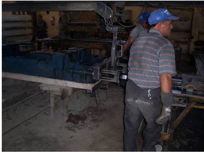
Resim 3.23 Beton traversten maça çubuklarının çıkarılması
