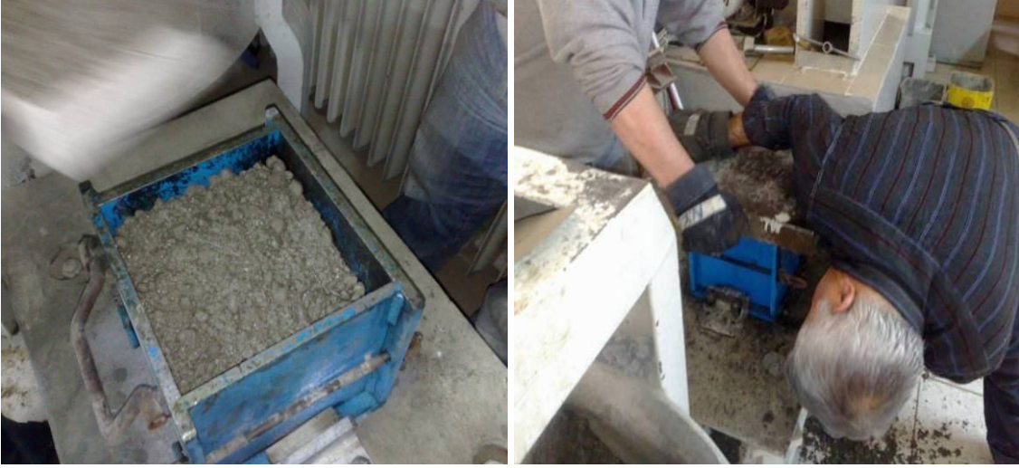
Resim 3.15 Küp kalıplarının doldurulması ve titreşime tabi tutulması
