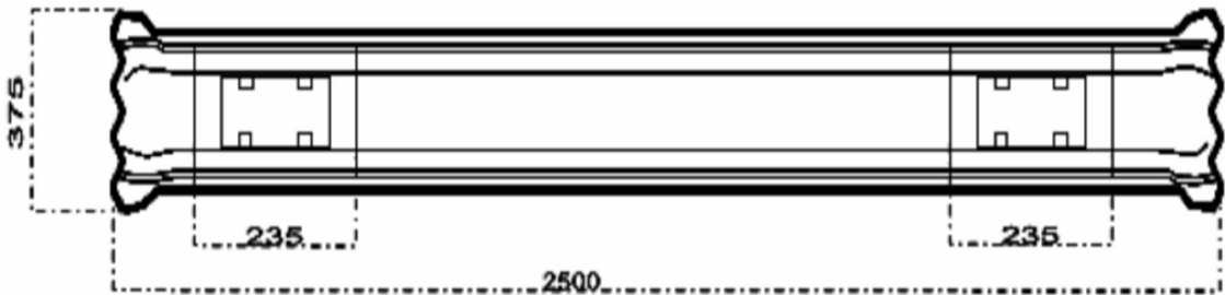
Şekil 2.10 49.050 kg/m tipi demir travers ve ölçüleri (Anonim 2008)
