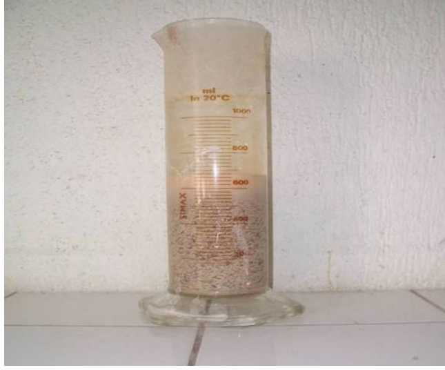
Resim 3.11 Agregalarda çamurlu madde miktarı deneyi yapılması
