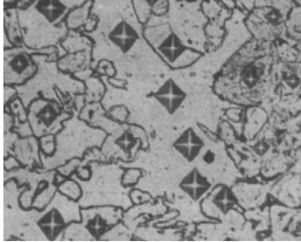
Resim 4.3 %0,3 C' lu çelik, 740 °C sıcaklıktan suda ani soğutulmuş X500. (Ferrit, Martensit).
