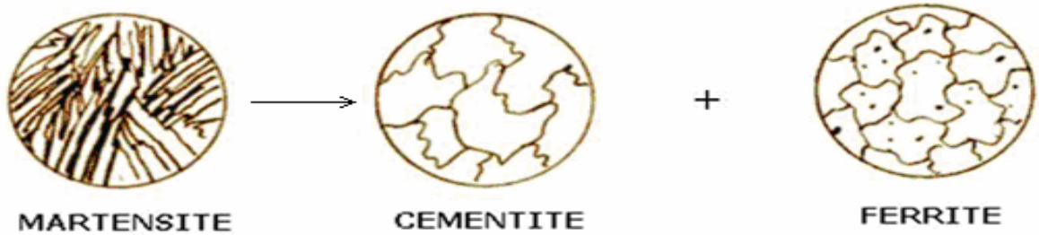
Şekil 4.16 Menevişleme’ de martenzitin, sementit ve ferrite dönüşümü (Ay 2008).
