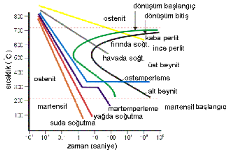
Şekil 4.10 Soğutma ortamlarının TTT diyagramıyla ilişkisi (İnt.Kyn.7).
