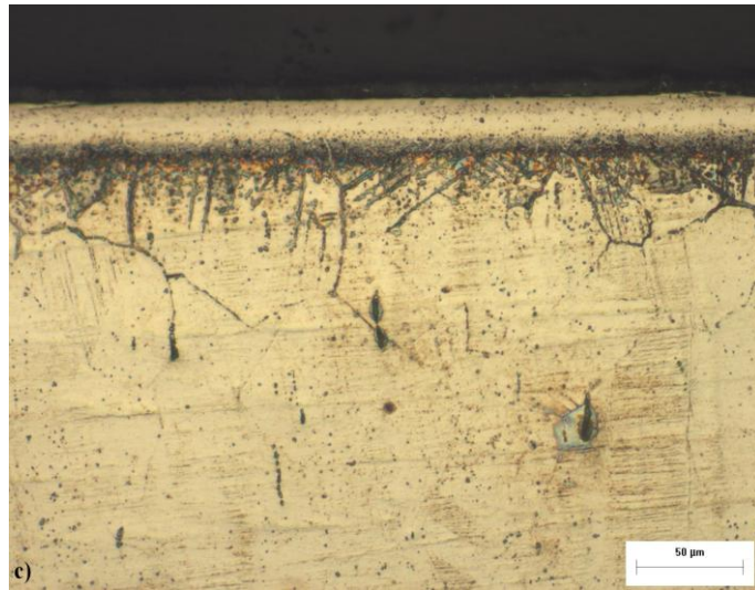
Şekil 4.3 900 °C’de a) 2 saat, b) 4 saat ve c) 6 saat borlanmış numunelerin mikroyapıları.
