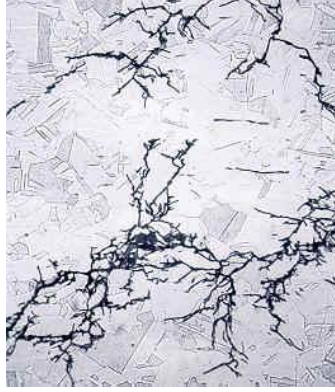
Şekil 2.23 AISI 316 östenitik paslanmaz çelikteki gerilmeli tanelerarası çatlak korozyonu (İnt Ky.6).
