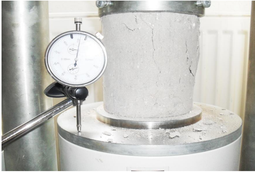
Őekil 3.10. Donma-zlme Sonrası Eksenel Basın Uygulaması
