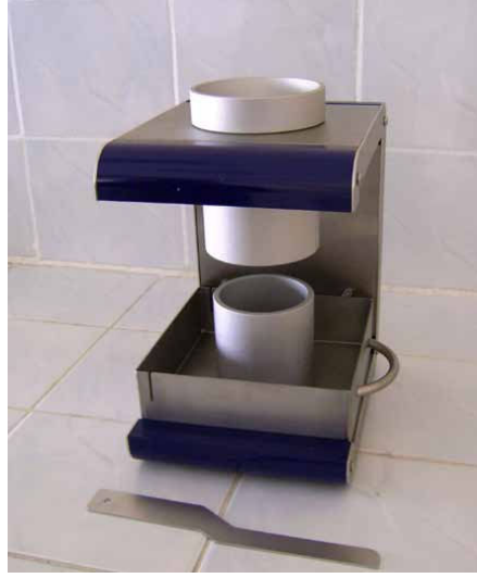
Şekil 3.11 Yığın yoğunluğu ölçüm aparatı.
