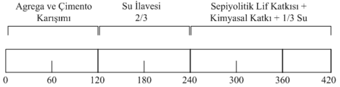
Şekil 3.19 Beton karılma işlem aşamaları.
