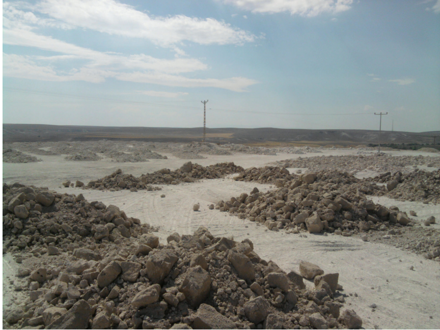
Şekil 2.6 Ocakta kurumaya bırakılan tüvenana sepiyolit.
