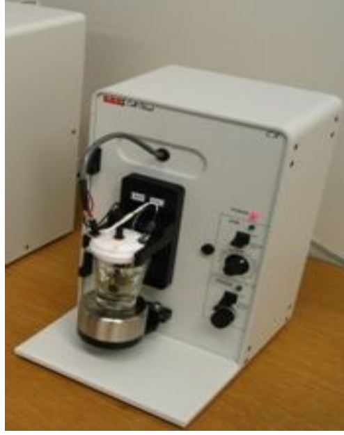
Şekil 3.2 Potansiyostat / Galvanostat sistemlerinde kullanılan hücre standı
