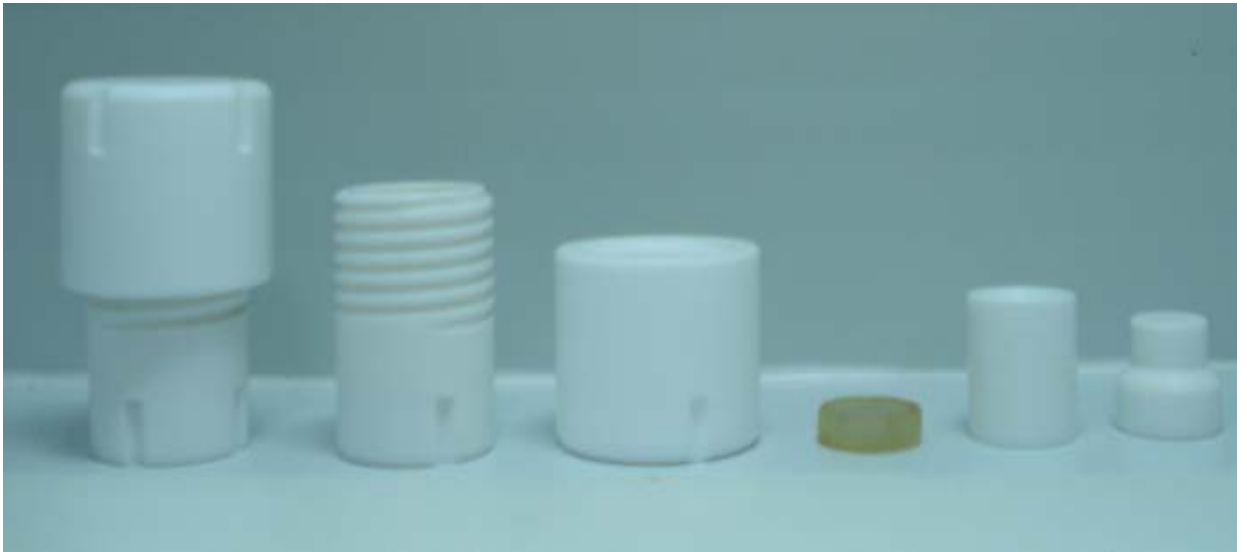
Resim 1.1 Özel tasarım mikrodalga reaksiyon kabının parçaları.
