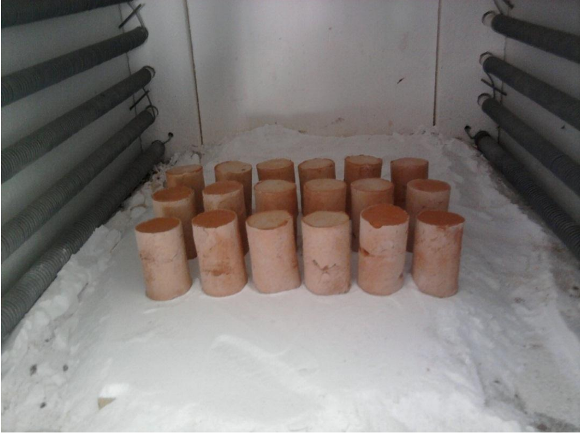
Resim 3.5 Numunelerin fırında pişirilmesi.
