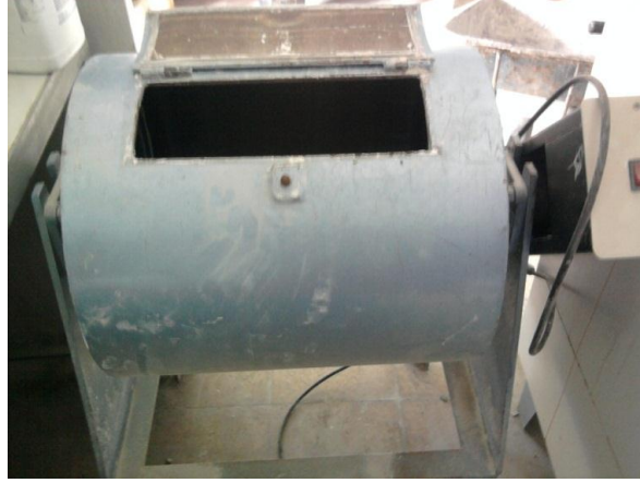
Resim 3.1 Malzemelerin öğütülmesinde kullanılan laboratuvar tipi bilyeli değirmen.
