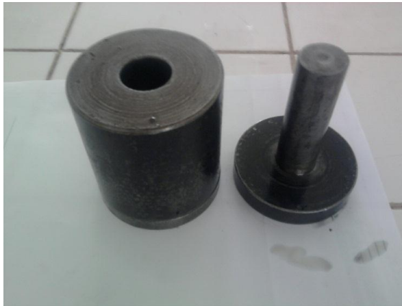
Resim 3.2 Numune şekillendirilmesinde kullanılan silindir kalıp.( Çapı 25mm, boy 80mm).
