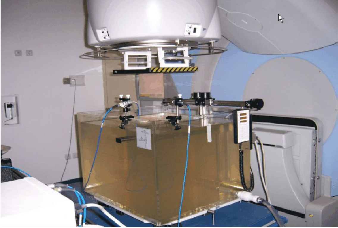
Resim 3.6 Lineer hızlandırıcıda iyon odalarının su fantomunda fantomda doz ölçümü
