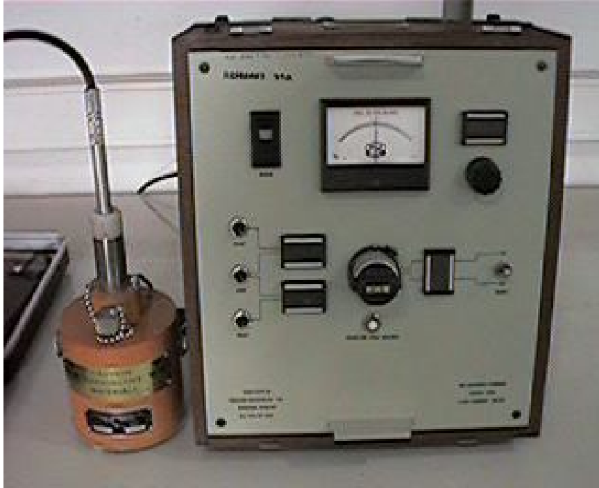
Resim 3.1 İyon odası ve elektrometre sızıntı testi yapıldığı düşük aktiviteli Sr-90 kaynağı
