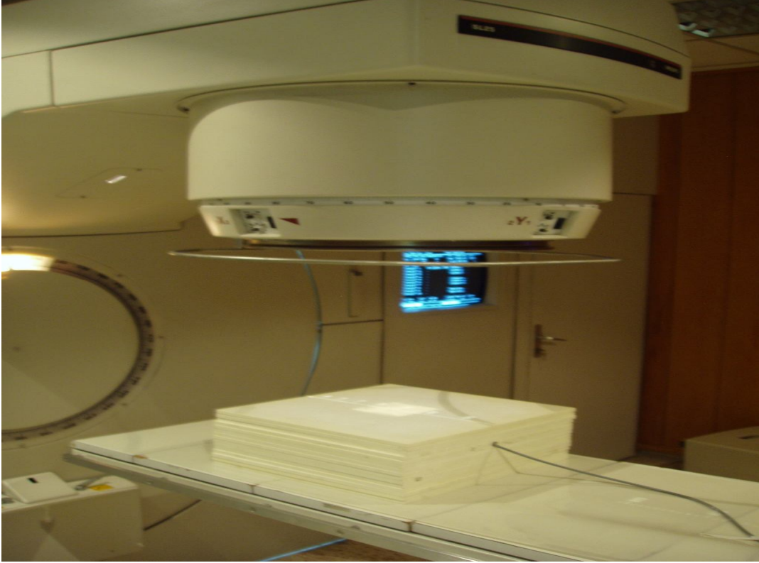
Resim 3.5 Lineer hızlandırıcıda iyon odalarının katı fantomda doz ölçümü
