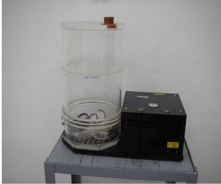
Resim 3.2 İyon odasının atmosfere açıklık testi
