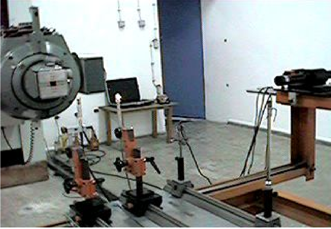
Resim 3.3 Hava kerma kalibrasyon işlemi
