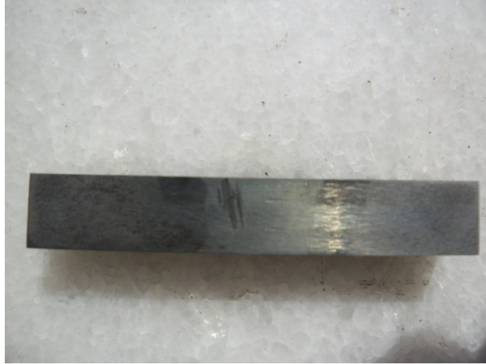
Şekil 4.16 4140 çeliği Tozaltı kaynağı
