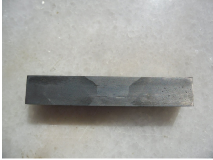
Şekil 4.15 2738 çeliği Tozaltı kaynağı
