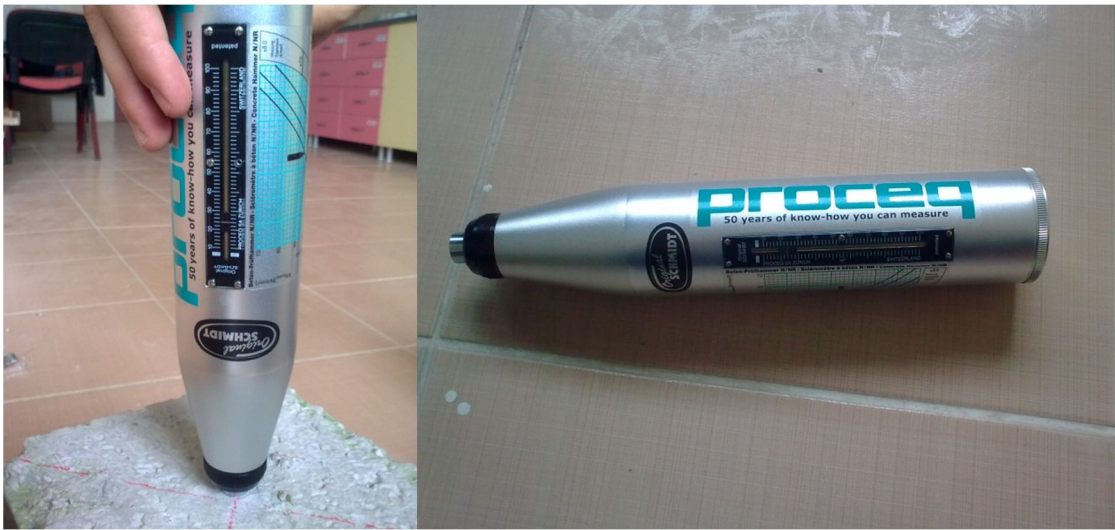
Resim 3.5. Yüzey sertlik ölçümlerinde kullanılan Schmidt çekicinin genel görünümü.
