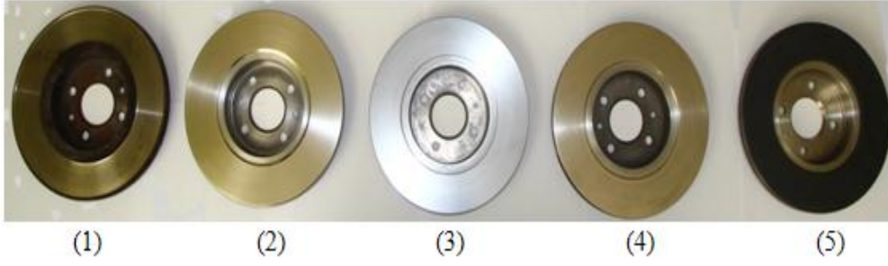
Resim 3.1 Çalışmada kullanılan fren disklerinin görünüşü. (1) Plazma püskürtme ile \text{Cr}_2\text{O}_3 - \%40\text{TiO}_2 kaplanmış disk, (2) Alev püskürtme ve ergitme ile \text{NiCrBSi} - \%35\text{W}_2\text{C} kaplanmış disk, (3) HVOF püskürtme yöntemi ile \text{W}_2\text{C} - \%12\text{Ni} kaplanmış disk, (4) Alev püskürtme ve ergitme ile \text{NiCrBSi} kaplanmış disk, (5) Orijinal disk.
