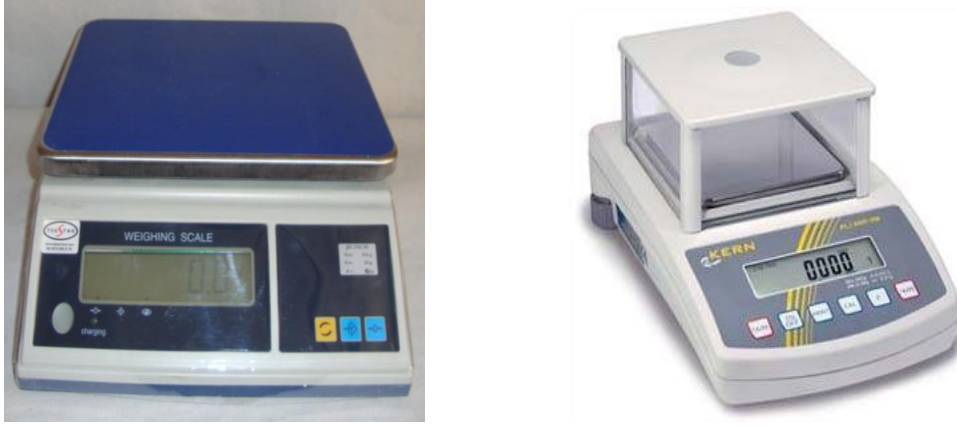
Resim 3.13 Disk ve balata ağırlıklarını ölçmede kullanılan teraziler.
