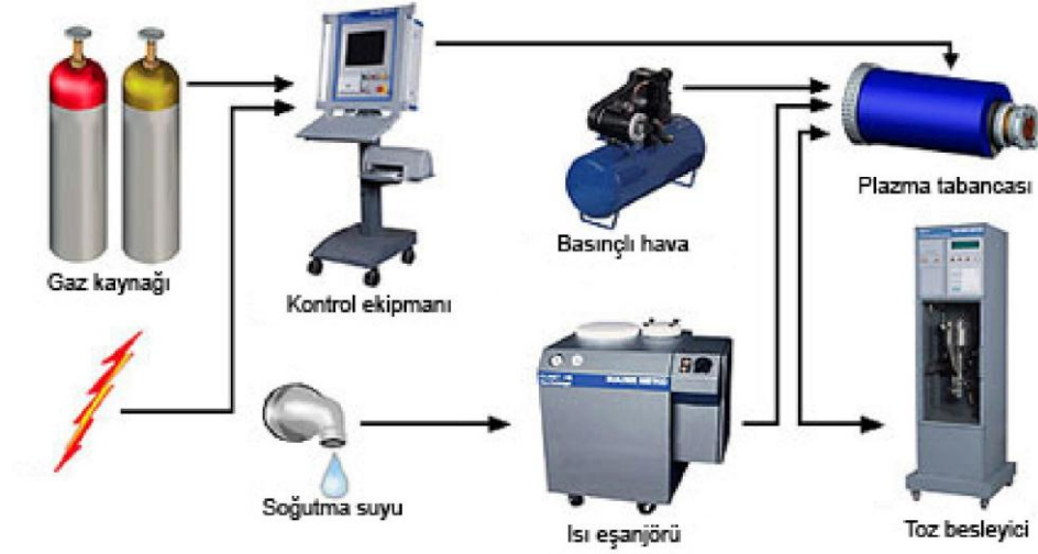
Şekil 2.3 Plazma püskürtme yönteminin düzeneği (İnt. Kay. 1).
