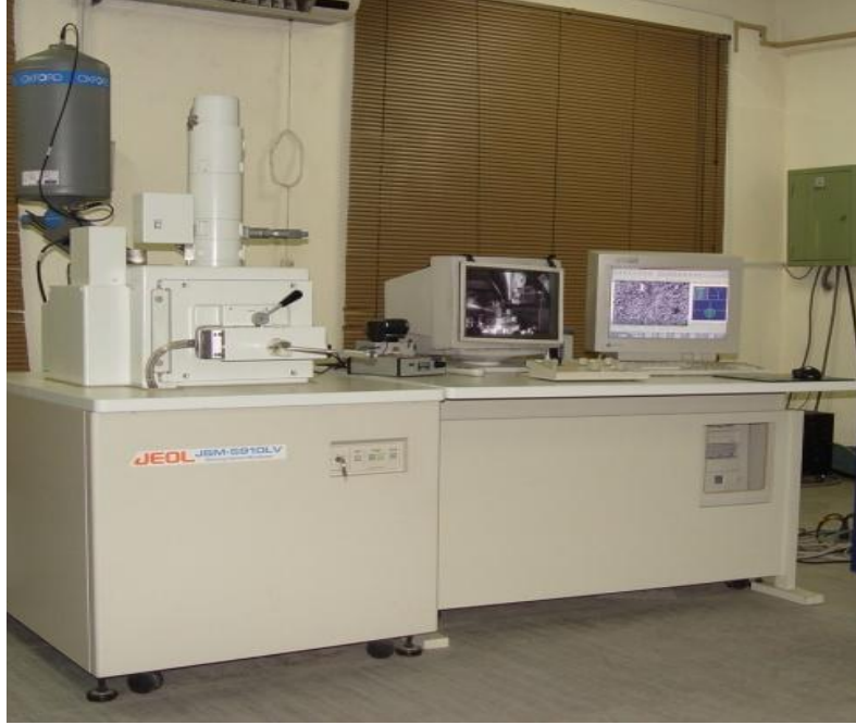
Resim 3.22 Enerji dağılımlı spektrometre ekipmanı ile taramalı elektron mikroskobu.
