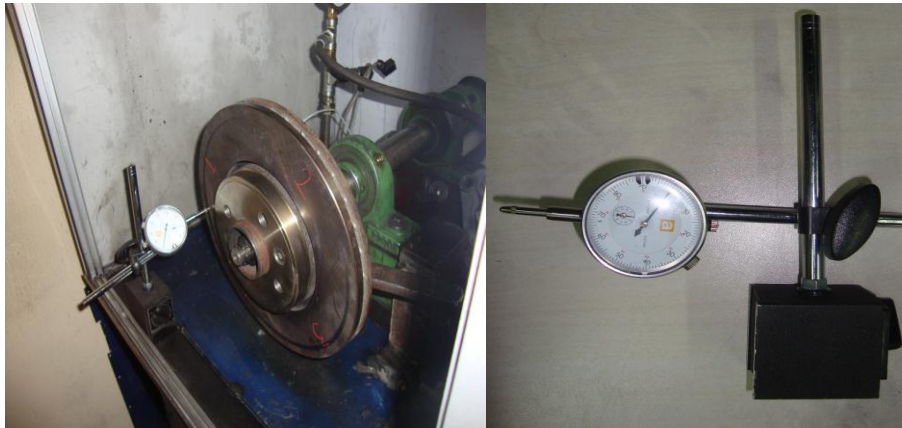
Resim 3.16 Disk salgılarının ölçümünde kullanılan komparatör.
