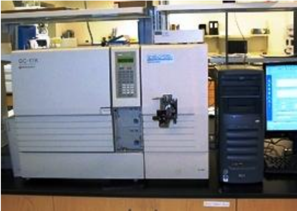
Şekil 3.5 Gaz kromatografisi – kütle spektrofotometresi (GC-MS) (İnt.Kyn.8)
