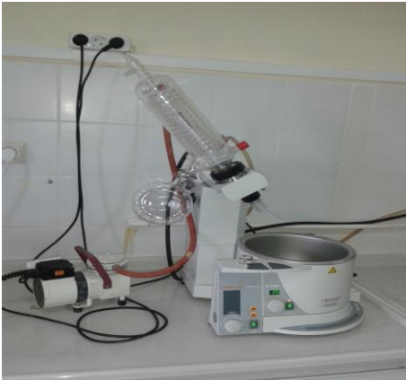
Şekil 3.4 Döner buharlaştırıcı ve elde edilen uçucu yağ
