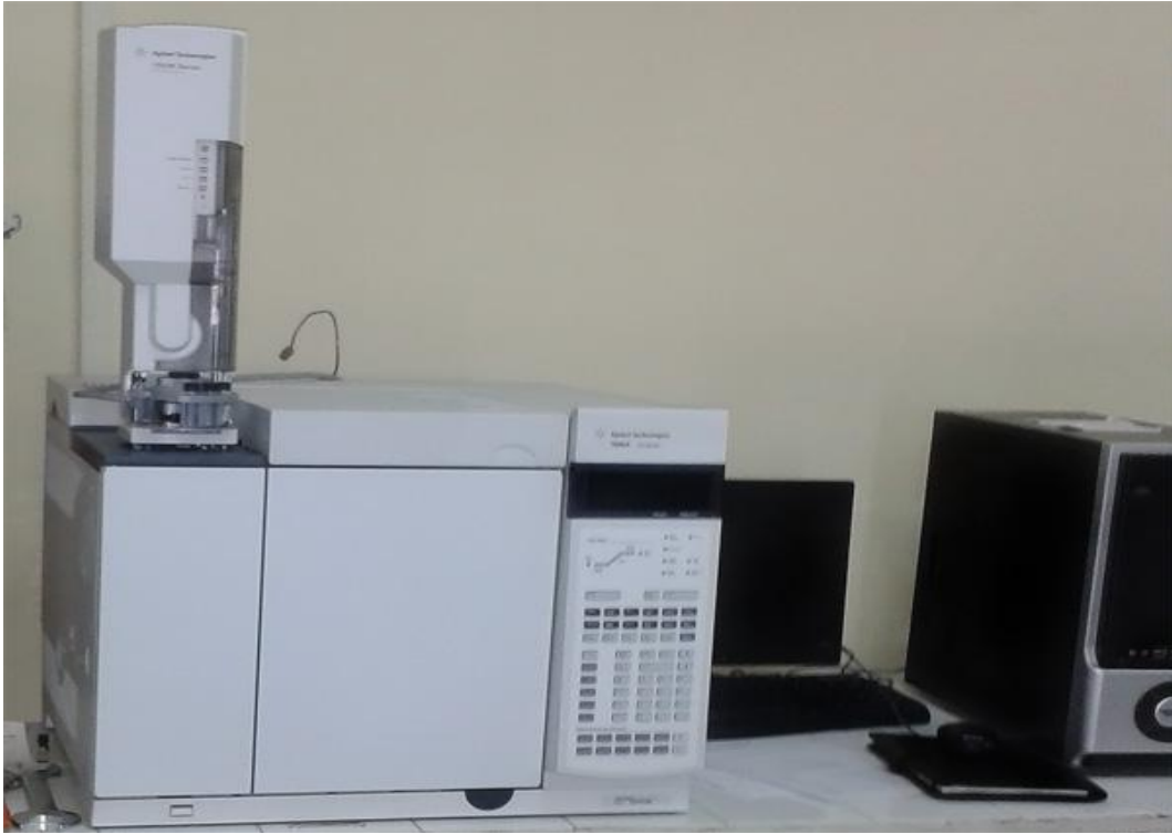
Şekil 3.6 Gaz kromatografisi (HP Agilent 7890 A GC System )
