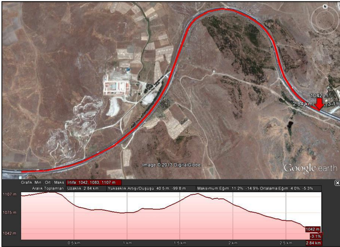
Şekil 4.4 Yol kesim no 300-07, 42, 43, 44 no'lu segmentlerin yatay ve düşey yol geometrisi
