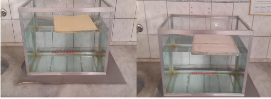
Resim 4.19 Aramid ve polietilen plakannın suda şartlandırılması
