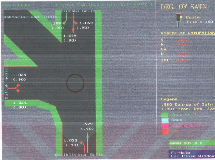
Şekil 6.10 Vilayet Önü Kavşağı'nda C=150 sn devre süresi için Akım Doygunluk Dereceleri
