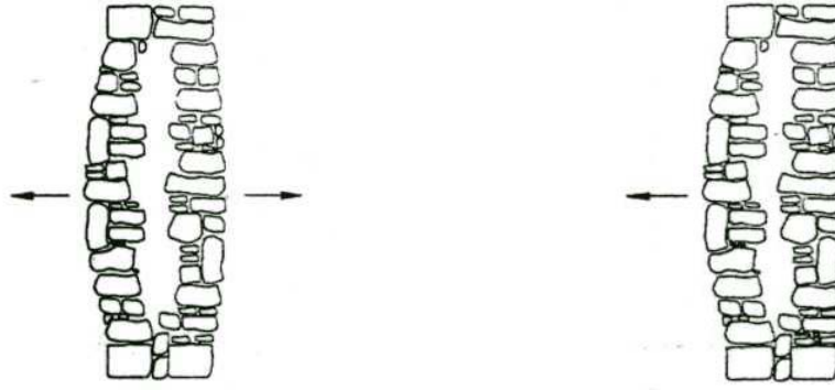
a) Düşey Yükler altında şişmiş taş yığma duvar
