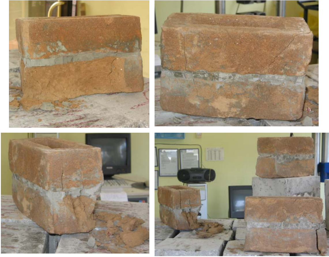
Şekil 5.21 : Basınç Deneyi Sonucu Tahrip Olan Numuneler
