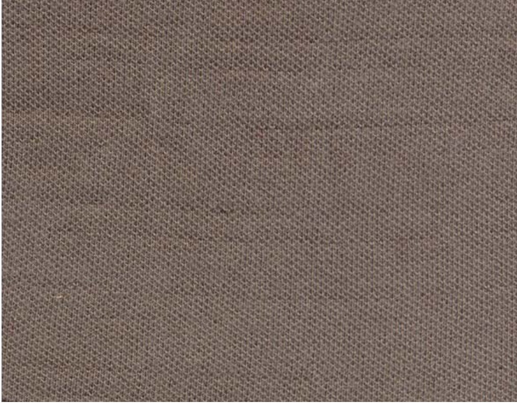
Şekil 4.5 : İplik Gerginlik Farkından Kaynaklanan Enine Kesikli Çizgi Hatasının Kumaş Yüzeyindeki Görüntüsü
