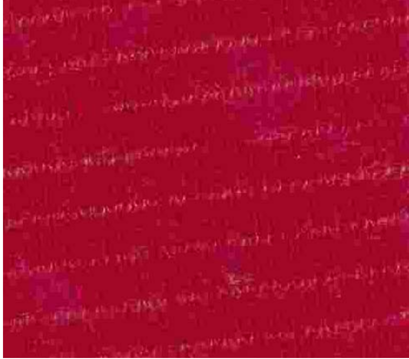
Şekil 4.4 : İplik Hammaddesinin Farklılığından Kaynaklanan Enine Çizgi Hatasının Kumaş Yüzeyindeki Görüntüsü
