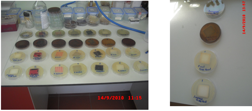
Şekil 6.6: Kumaş numunelerinin AATCC 147 standardına göre 4 ayrı organizma ile çalışılma görüntüsü
