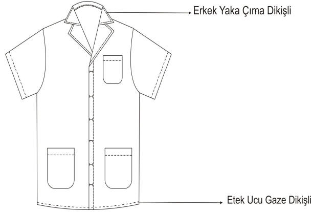
Şekil 7.5: Erkek modeli teknik çizimi
