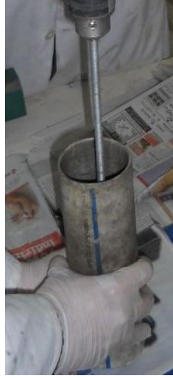
Şekil 3.15 : Piston silindir sisteminin mekanik karıştırıcı altına yerleştirilmesi
