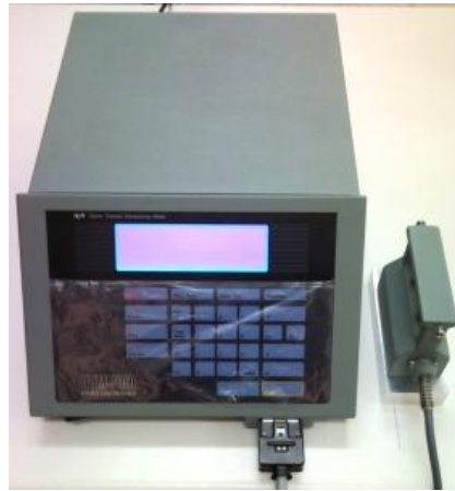
Şekil 3.39 : Kyoto Electronics QTM-500 ısı iletım katsayısı ölçüm cihazı
