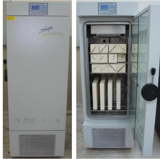
Şekil 3.7 : Şartlandırıcı ünitesi ve üretilen malzemelerin şartlandırıcıya yerleştirilmesi
