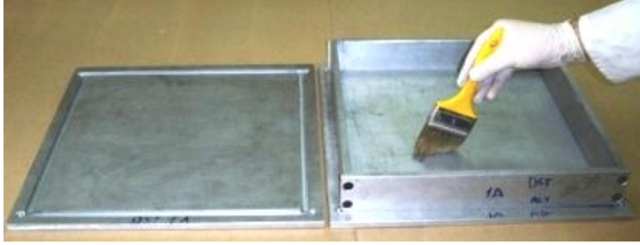
Şekil 3.12 : Kalıba kalıp ayırıcı sürülmesi
