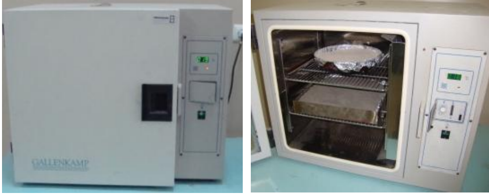
Şekil 3.5 : Katkı ve dolgu maddelerinin fırında kurutulması
