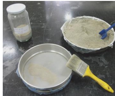
Şekil 4.21 : UK'ün 25 µm altı elek ile elenmesi
