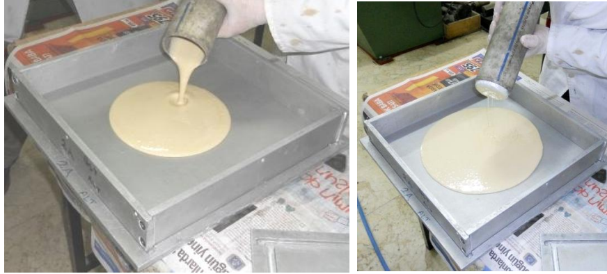
Şekil 3.16 : PUR karışımının piston silindir sistemi ile kalıba enjekte edilmesi
