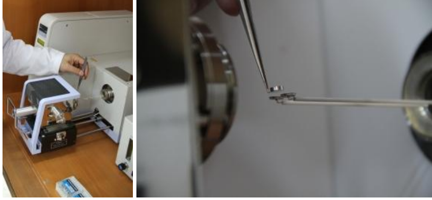
Şekil 3.44 : TGA ısıtma hücresine numune konulması
