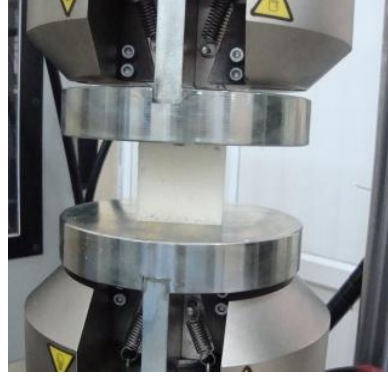
Şekil 3.32 : Basma çenelerine numune yerleştirilmesi
