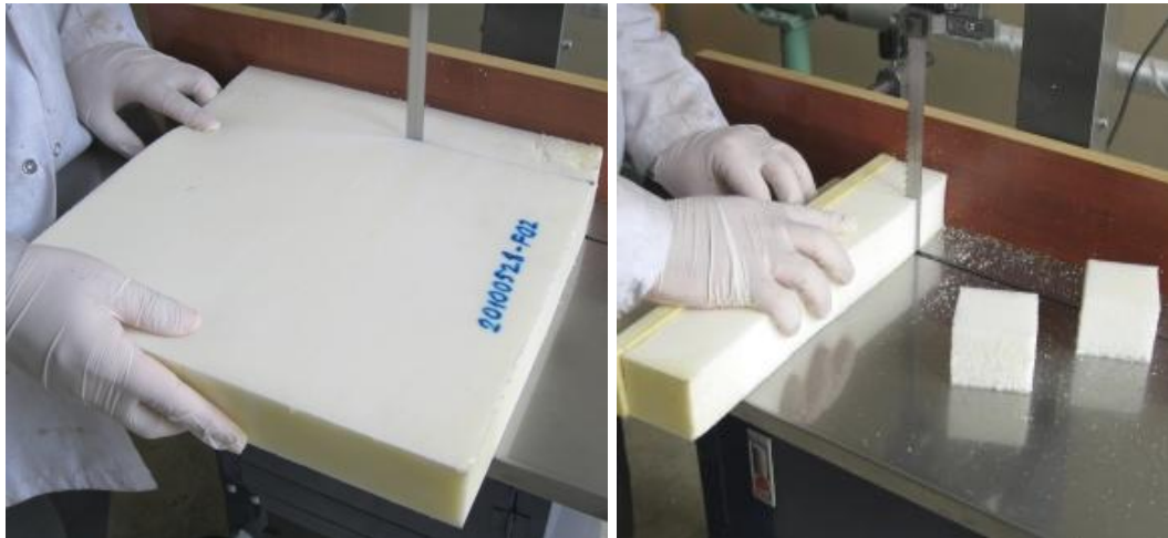
Şekil 3.29 : Basma numunelerinin testerede kesilip hazırlanması
