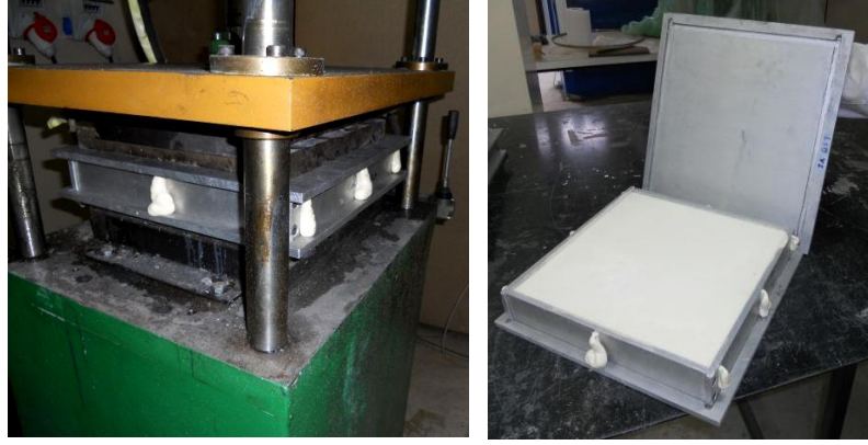
Şekil 1.9 : Poliüretan köpüğün kalıp içerisinde pres altında üretimi
