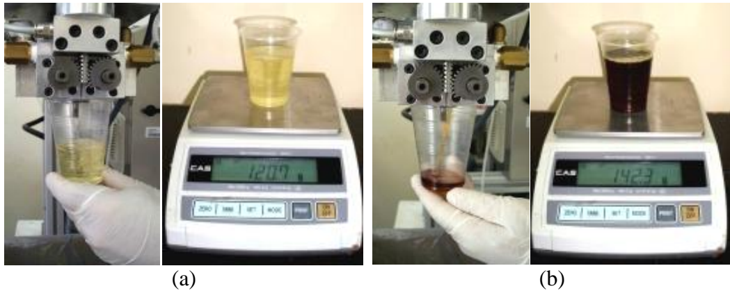
Şekil 3.22 : Dozajlama işleminde döküm alıp tartılması (a) poliol ve (b) izosiyanat
