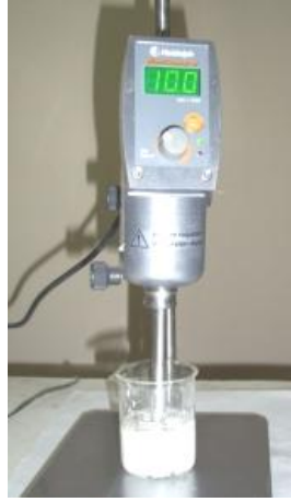
Şekil 3.13 : Poliöl ile katkı maddesinin homojenize edilmesi
