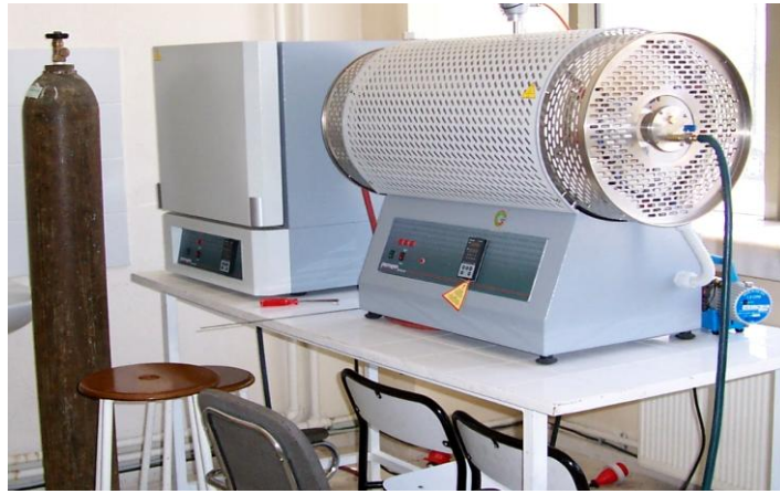
Resim 3.2 Oksidasyon işleminde kullanılan fırının fotoğrafı.
