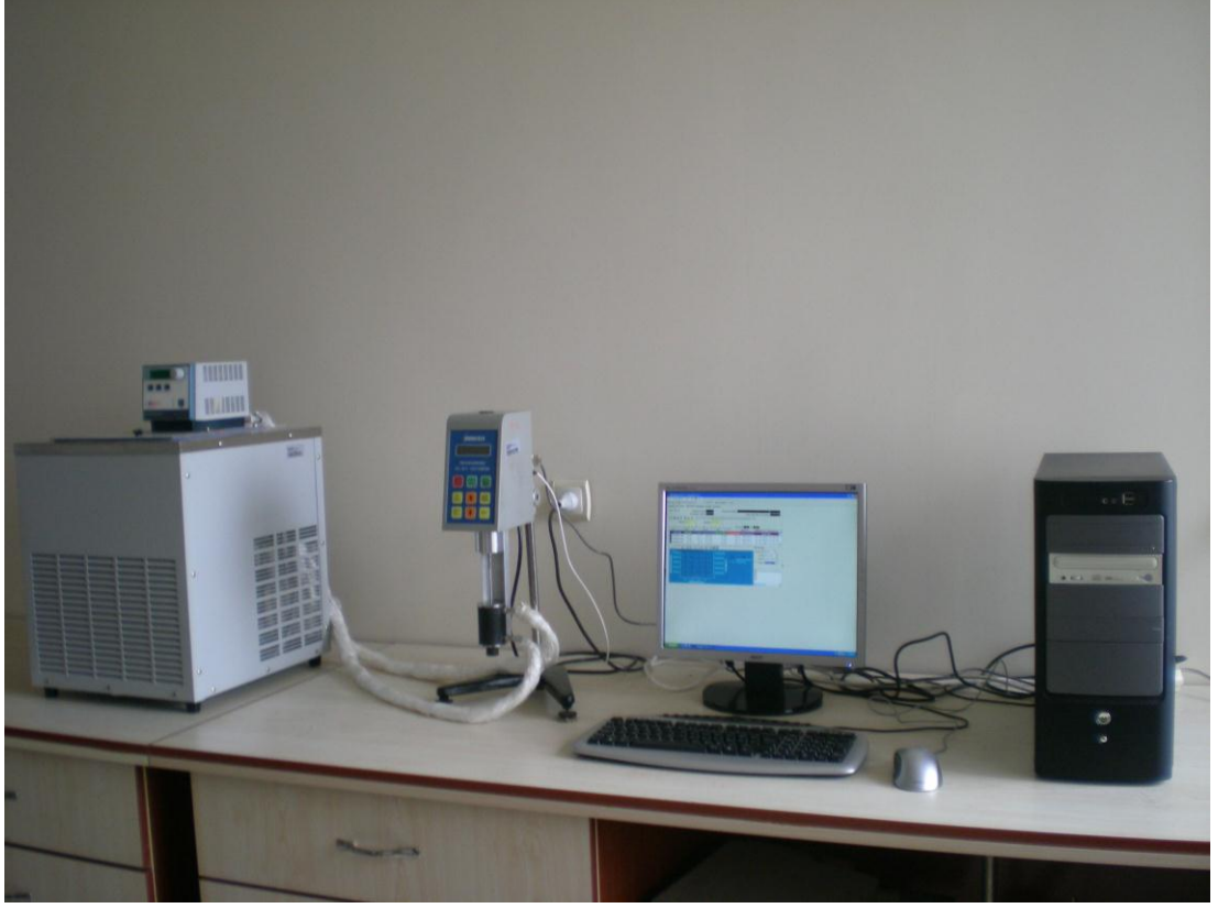
Şekil A2 : Reolojik ölçümlerin yapıldığı viskometre.
