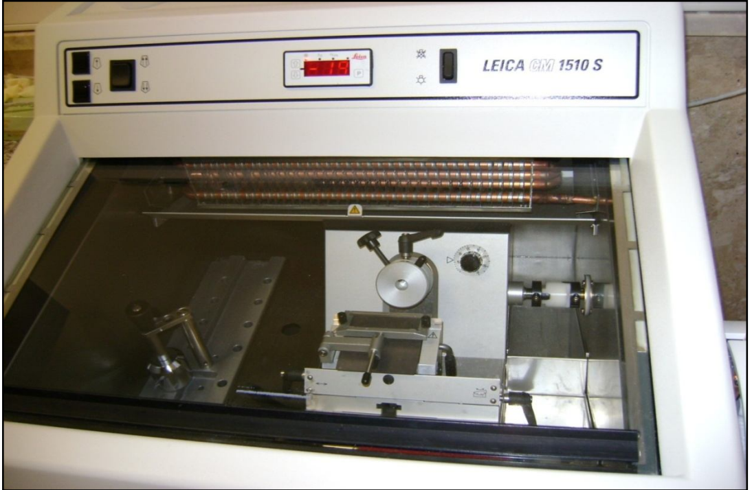
Şekil 5.9: Mikrotom yardımı ile dokulardan kesit alma
