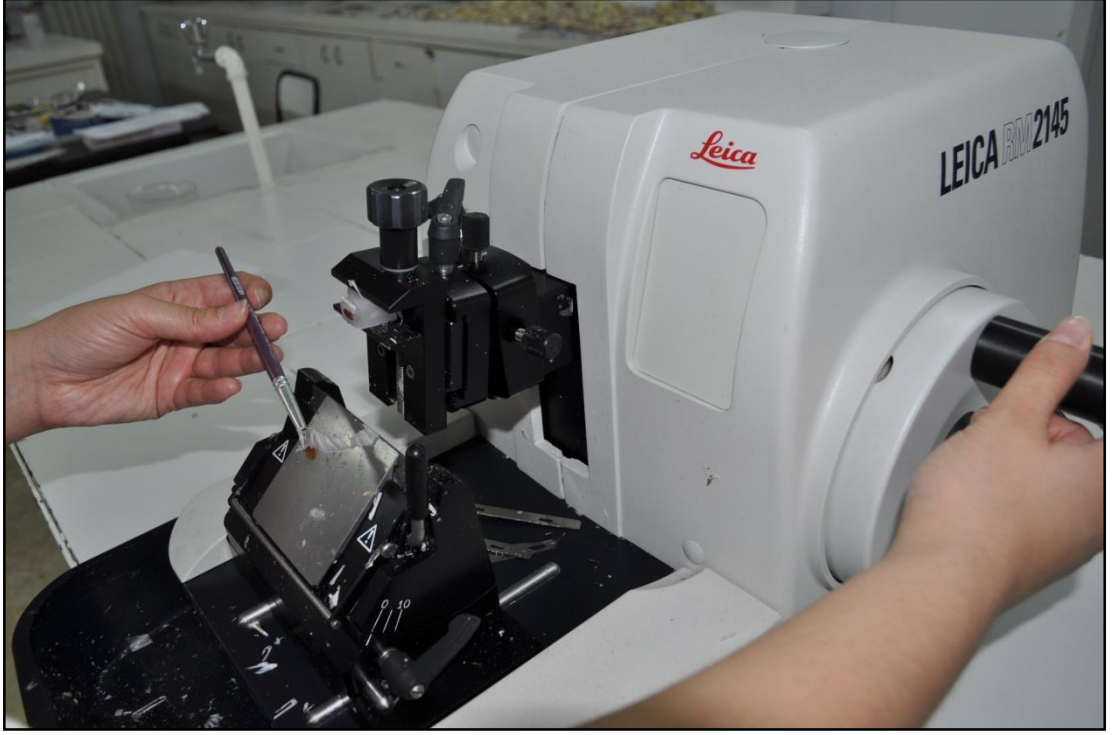
Şekil 5.9: Mikrotom yardımı ile dokulardan kesit alma
