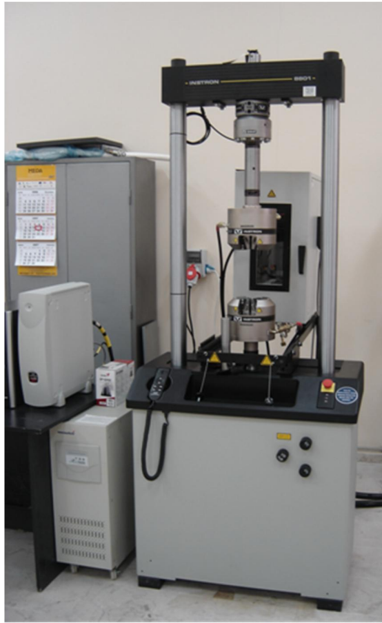
Şekil 4.9 : 8801 Instron statik/dinamik test cihazı
