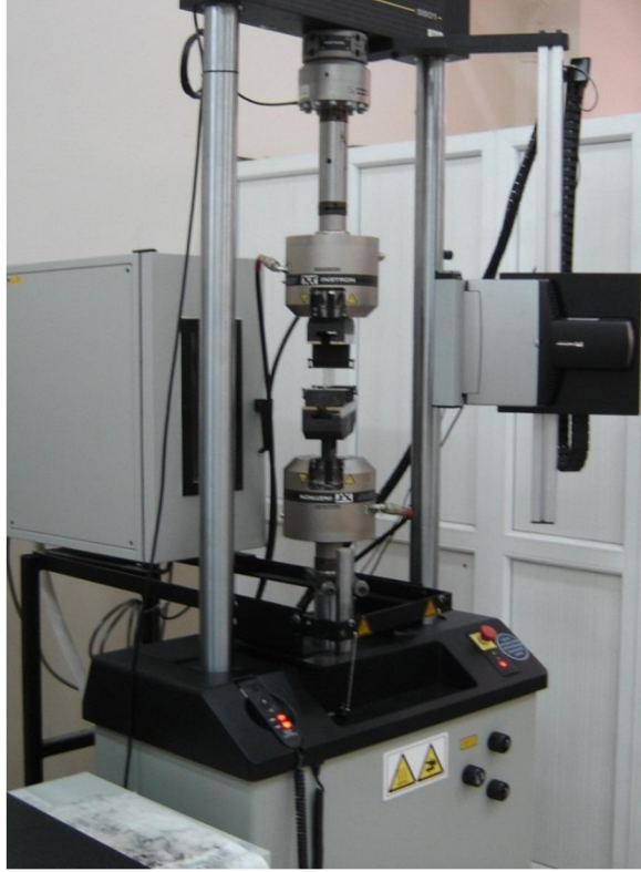
Şekil 4.11 : Üç nokta eğilme test aparatının Instron hidrolik test cihazına bağlanmış durumu
