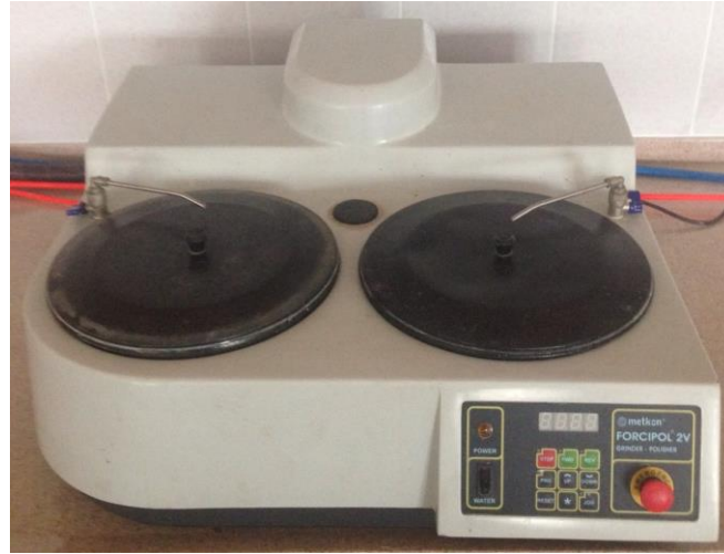
Resim 3.11 Zımparalama ve parlatma cihazı (Gripo 2V marka).
