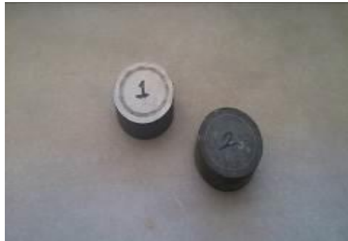
Resim 3.4 Borlama işlemi öncesi ve sonrası numunelerin görünüşü.
