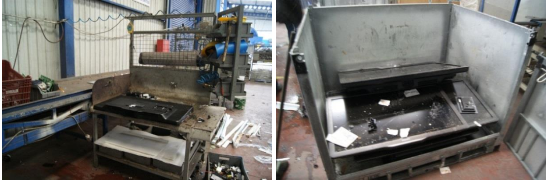
Şekil 5.5 : İş istasyonlarında demontaj operasyonları ve iş istasyonu çevresinde yer alan e-atıklar
