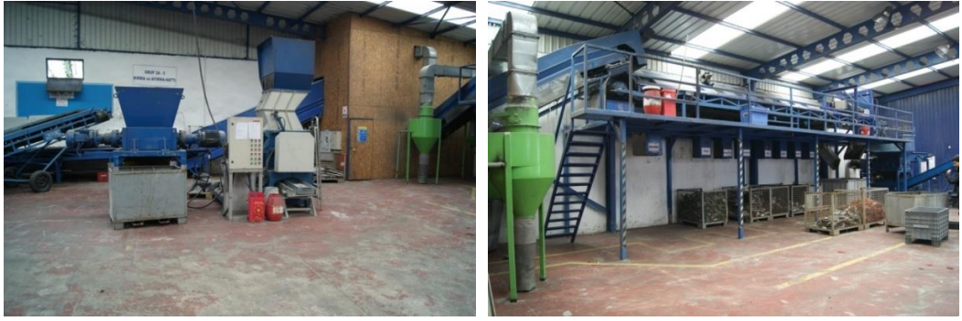
Şekil 5.10 : Zincirli kırıcı ve manuel ayırma bandı
