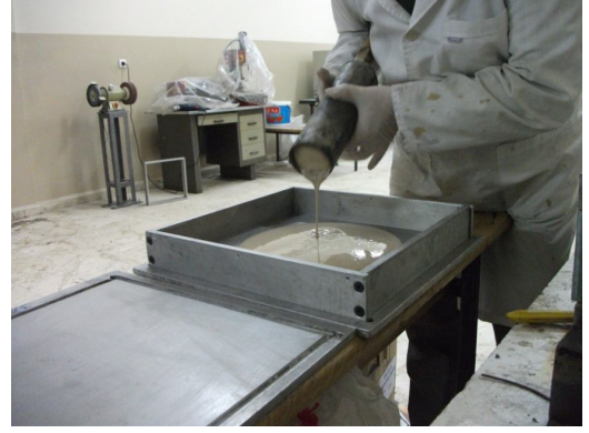
Şekil 3.11 : Karışımın kalıba boşaltılması.
