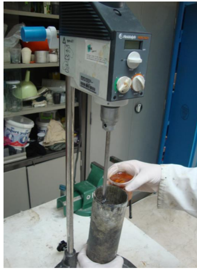
Şekil 3.10 : Polioller sistem ile izosiyanatın mekanik karıştırıcıda karıştırılması.
