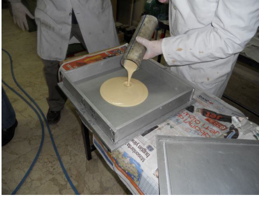
Şekil 3.11 : Karışımın kalıba boşaltılması.
