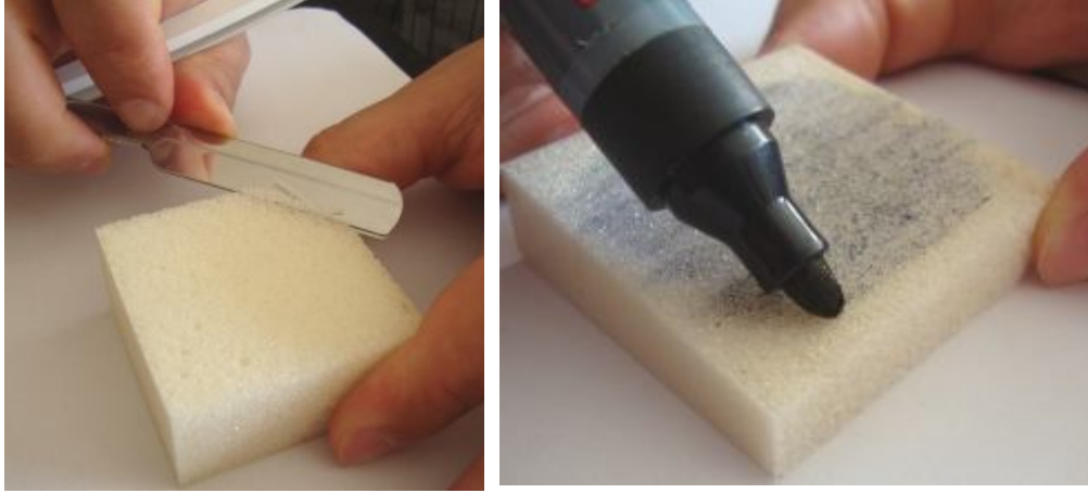
Şekil 3.19 : SPK malzemenin yüzeyinin (a) kesimi ve (b) boyanması.
