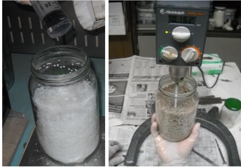
Şekil 3.15 : TPU ve PP karışımı ile dolgu maddelerinin karıştırılması.
