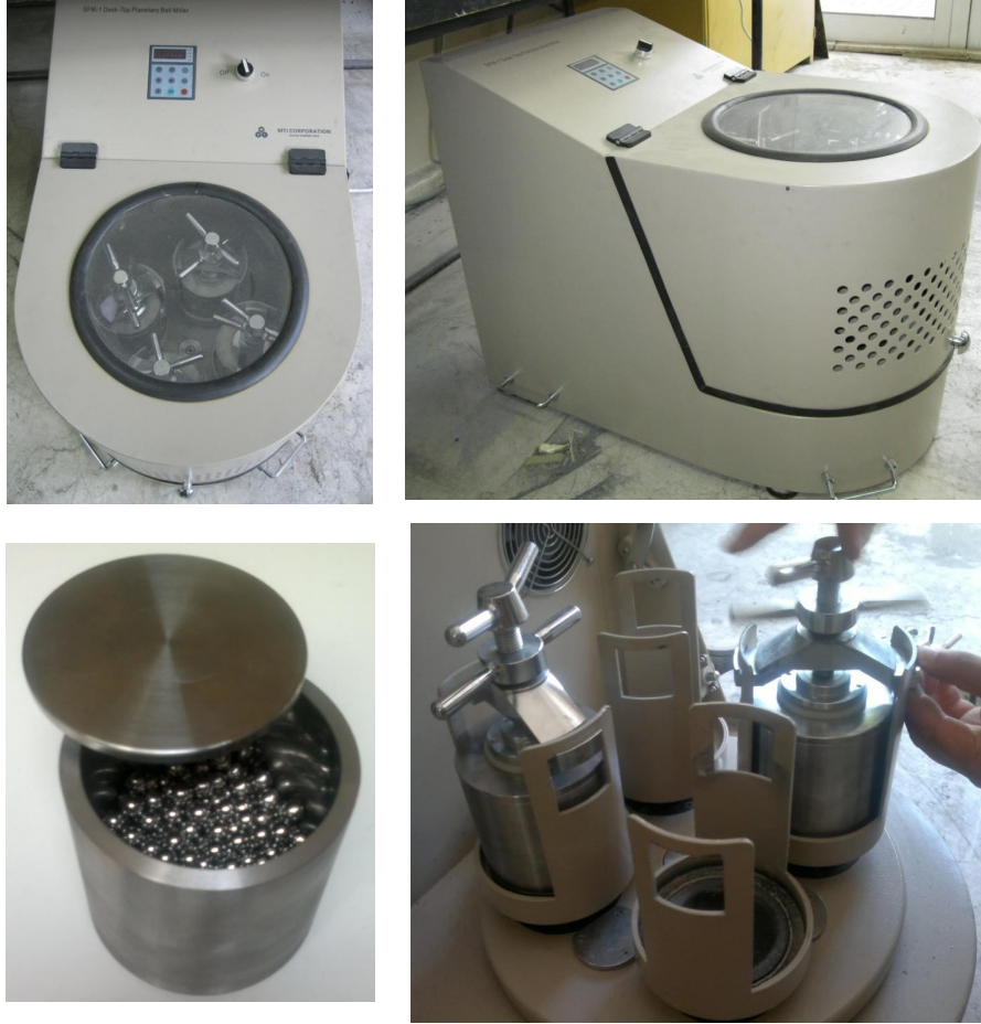
Şekil 3.1 : Planet sistemli öğütücü ve uçucu külün öğütülmesi.
