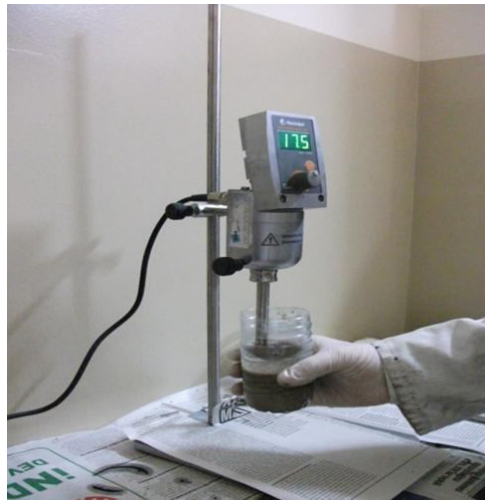
Şekil 3.8 : Poliole ilave edilen maddelerin homojenize edilmesi.
