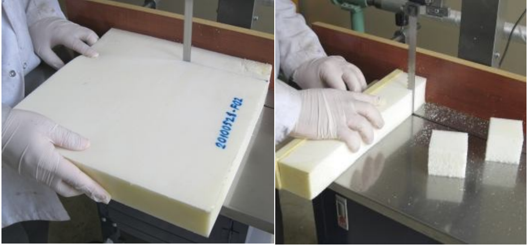
Şekil 3.17 : Numunelerin şerit testerede kesilip hazırlanması.
