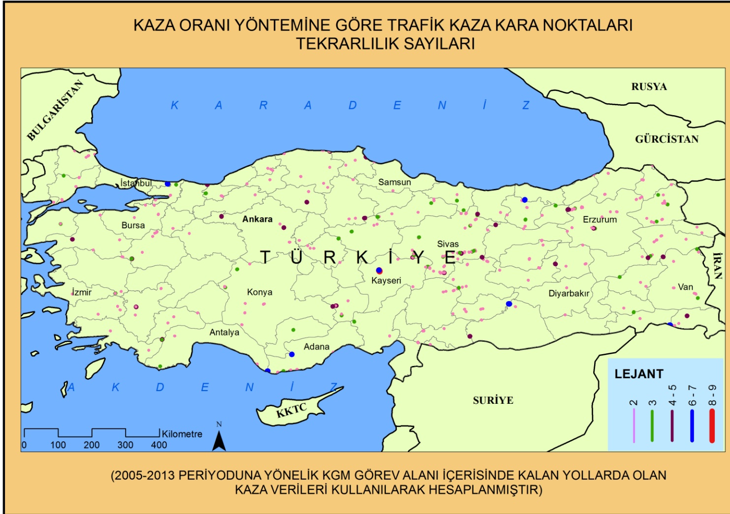
Şekil 4.9 Kaza oranı metoduna göre belirlenen trafik kaza kara noktaları ve 9 yıllık periyod içinde tekrar belirlenme sayıları.
