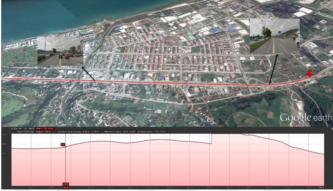
Resim 5.2 Yol kesim no 300-18, 31442, 31443, 31444 ve 31445 no'lu segmentlere ait yatay ve düşey yol geometrileri ve yol görüntüleri.
