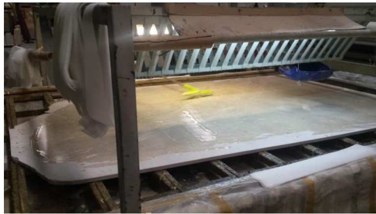
Resim 3.4: Plaka Epoksi uygulama İşlemi
