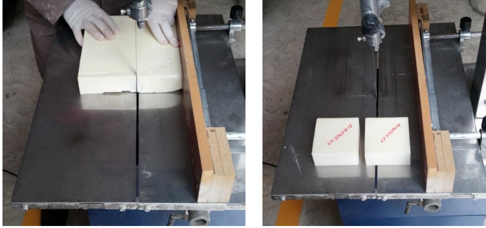
Şekil 3.9: Üretilen köpüklerin test cihazları için uygun boyutlara getirilmesi
