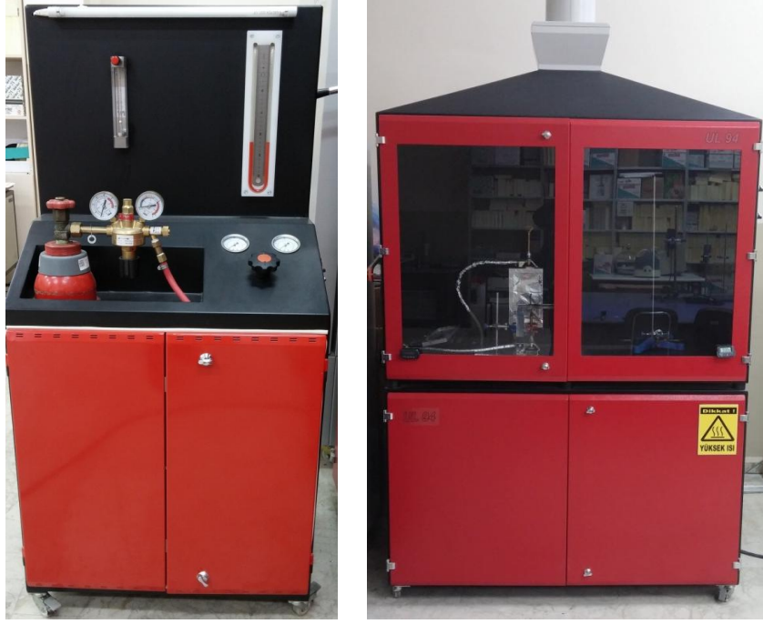
Şekil 3.17: UL-94 yanma testi düzeneği ve kabini
