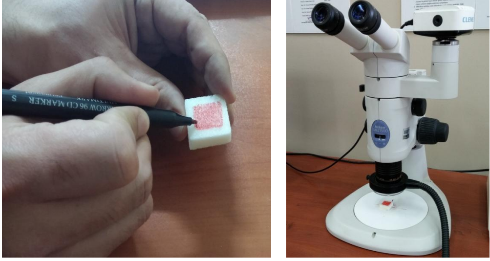
Şekil 3.13: Hücre boyutu tespit işlemi ve Nikon marka mikroskop cihazı
