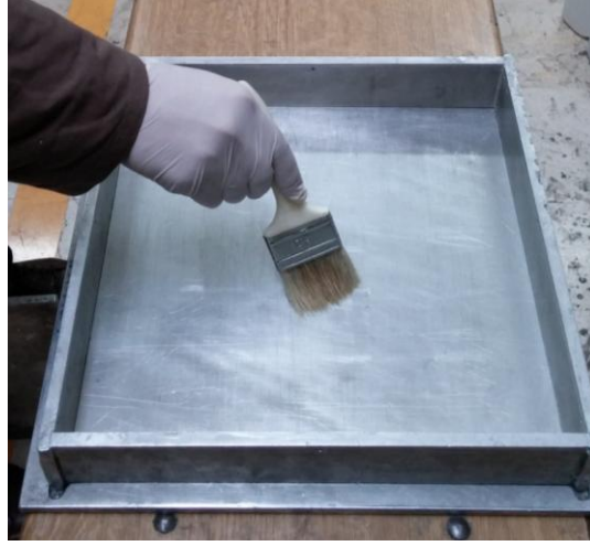
Şekil 3.6: Kalıbın iç yüzeylerine kalıp ayırıcı sürülmesi
