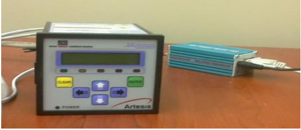
Şekil 3.6: Motor durum izleme cihazı (MDiC)
