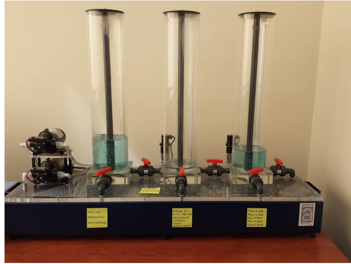
Şekil 5-1: Üç-tank sıvı-seviye sistemi
