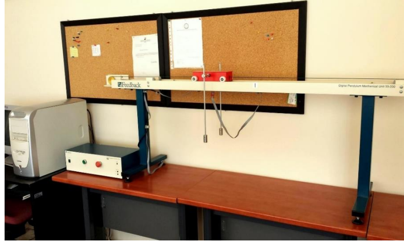
Şekil 5-3: Ters sarkaç sistemi
