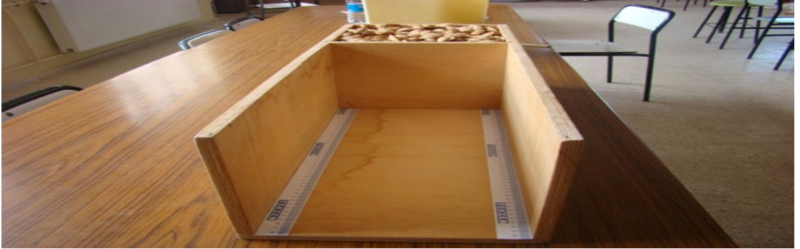
Şekil 3.2 Yığın açısı ölçümü
