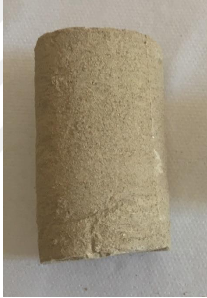
Şekil 4.16: Kohezyonlu güçlendirilmiş zemin
