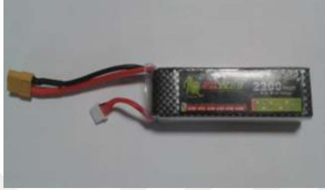
Resim 3.2 2200 mAh'lik MT-İHA bataryası.
