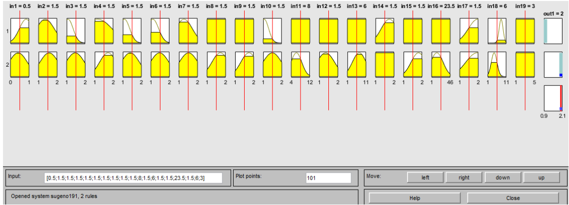
Şekil 19: Dilsel kuvvetli sınır-bulanık sınıflayıcı'ya ait bulanık kuralların modeli
