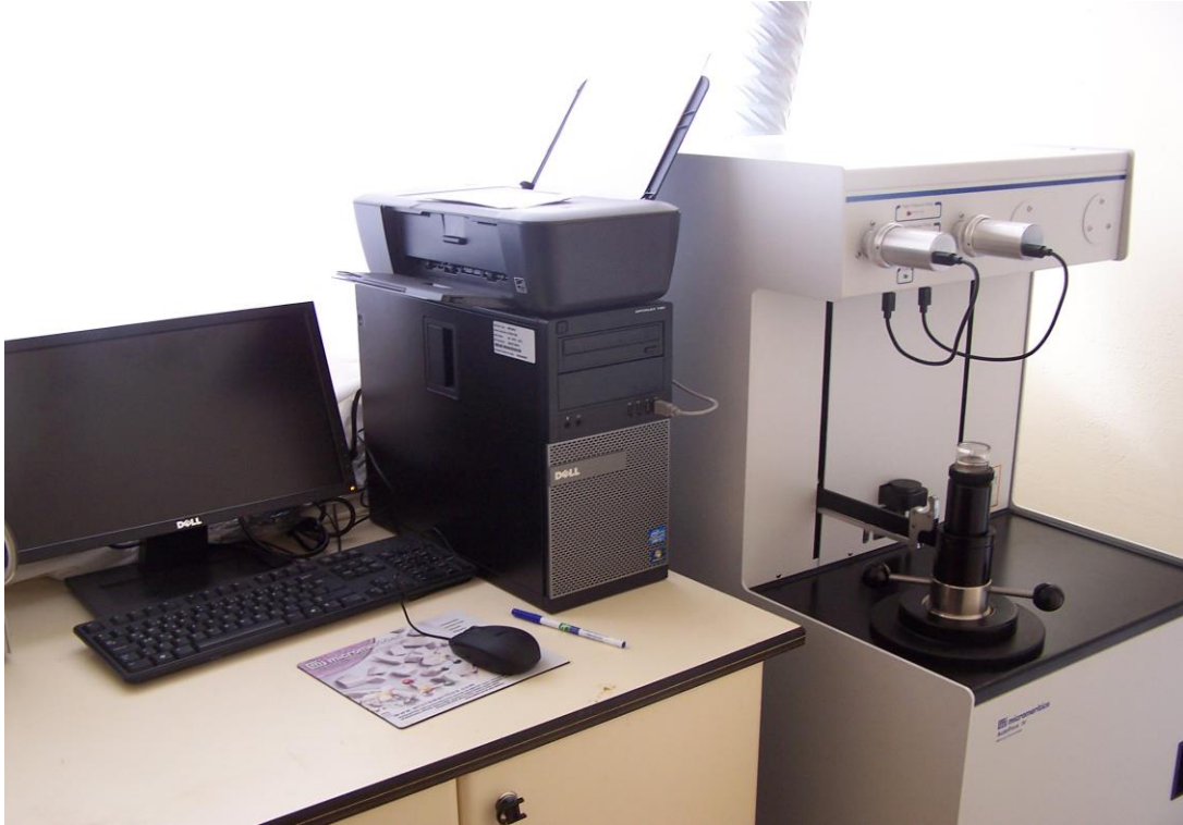
Resim 3.5 Micromeritics marka Hg-porozimetre cihazı.
