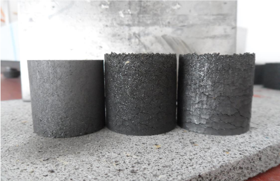
Resim 4.1 B-c, C-c ve D-c kodlu numunelerin 200 °C’de 2 saat kür sonrası görüntüleri.
