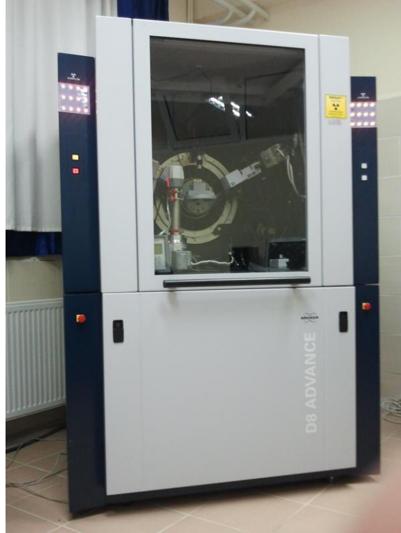
Resim 3.9 Bruker marka D 8 advance model x ışınları kırınımı XRD cihazı.
