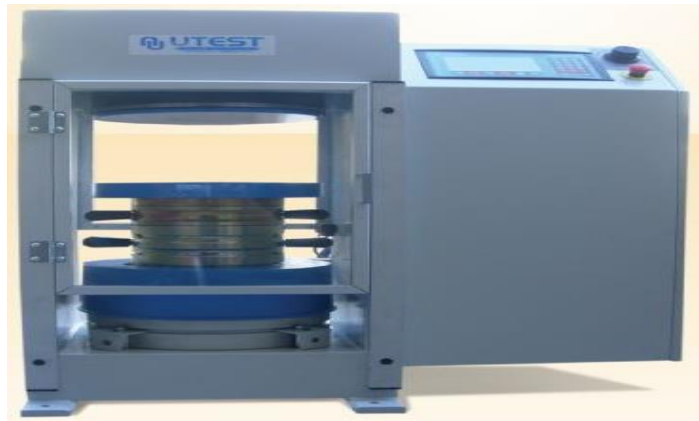
Resim 3.6 Utest marka otomatik basma cihazı.
