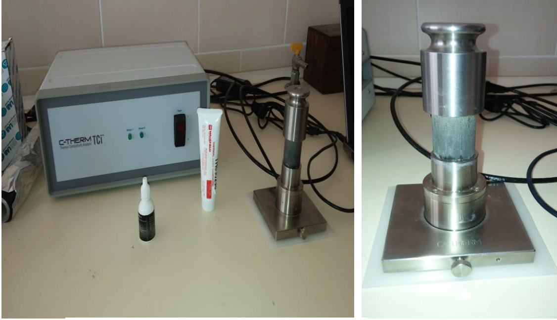
Resim 3.7 TCI marka termal iletkenlik katsayısı ölçüm cihazı.
