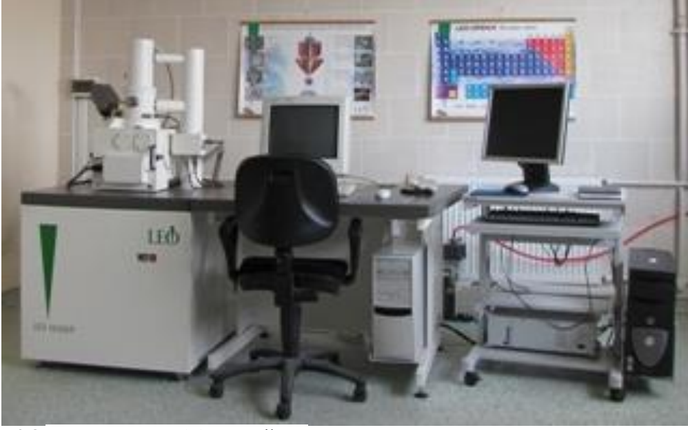
Resim 3.8 Leo 1430 vp model SEM cihazı.
