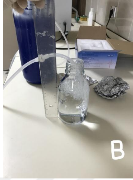
Şekil 3.2. Ozonatör cihazı (A), Distile suyun ozonlanması (B)
