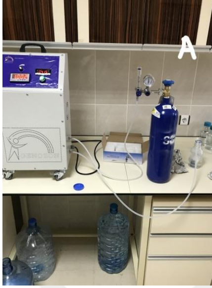
Şekil 3.2. Ozonatör cihazı (A), Distile suyun ozonlanması (B)
