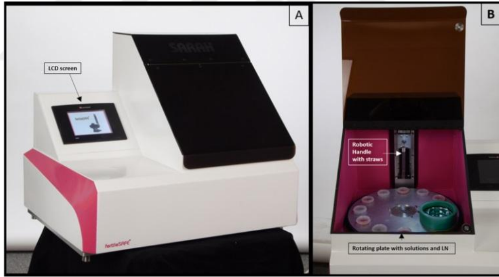
řekil 2.3. Sarah cihazının iki resmi. A) LCD ekranlı kapalı cihaz, B) Payet ile birlikte robotik kolu, solüsyonları ve sıvı azot konteyneri ile birlikte dönen metal plaęı gösteren açık cihaz (Arav ve ark., 2018).
