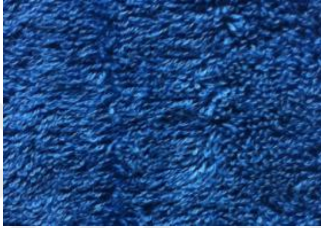
Şekil 4.10: 10 Tekrarlı Sürtme Testi Kumaşın Yüzey Görünümü (Ne16/1)
