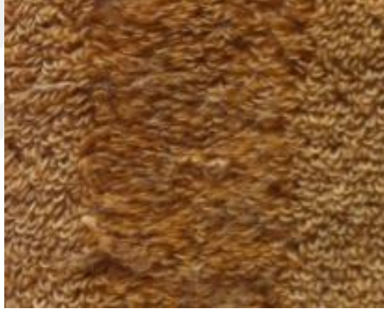
Şekil 4.14: 10 Tekrarlı Sürtme Testi Kumaşın Yüzey Görünümü (Ne16/1 Microcotton)
