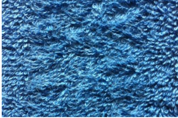
Şekil 4.11: 110 Tekrarlı Sürtme Testi Kumaşın Yüzey Görünümü (Ne16/1)
