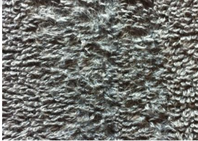
Şekil 4.13: 110 Tekrarlı Sürtme Testi Kumaşın Yüzey Görünümü (Ne16/1 Open-end)
