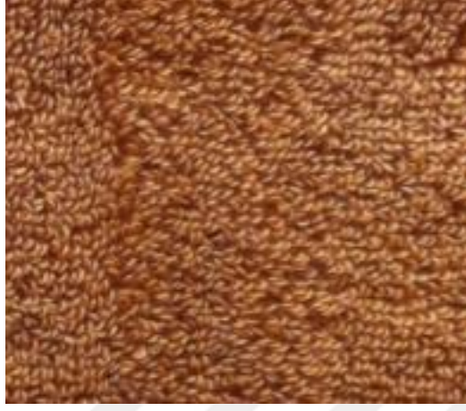
Şekil 4.14: 10 Tekrarlı Sürtme Testi Kumaşın Yüzey Görünümü (Ne16/1 Microcotton)
