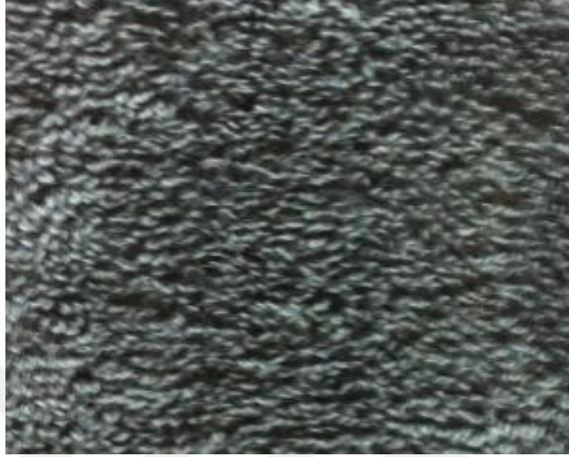
Şekil 4.12: 10 Tekrarlı Sürtme Testi Kumaşın Yüzey Görünümü (Ne16/1 Open-end)
