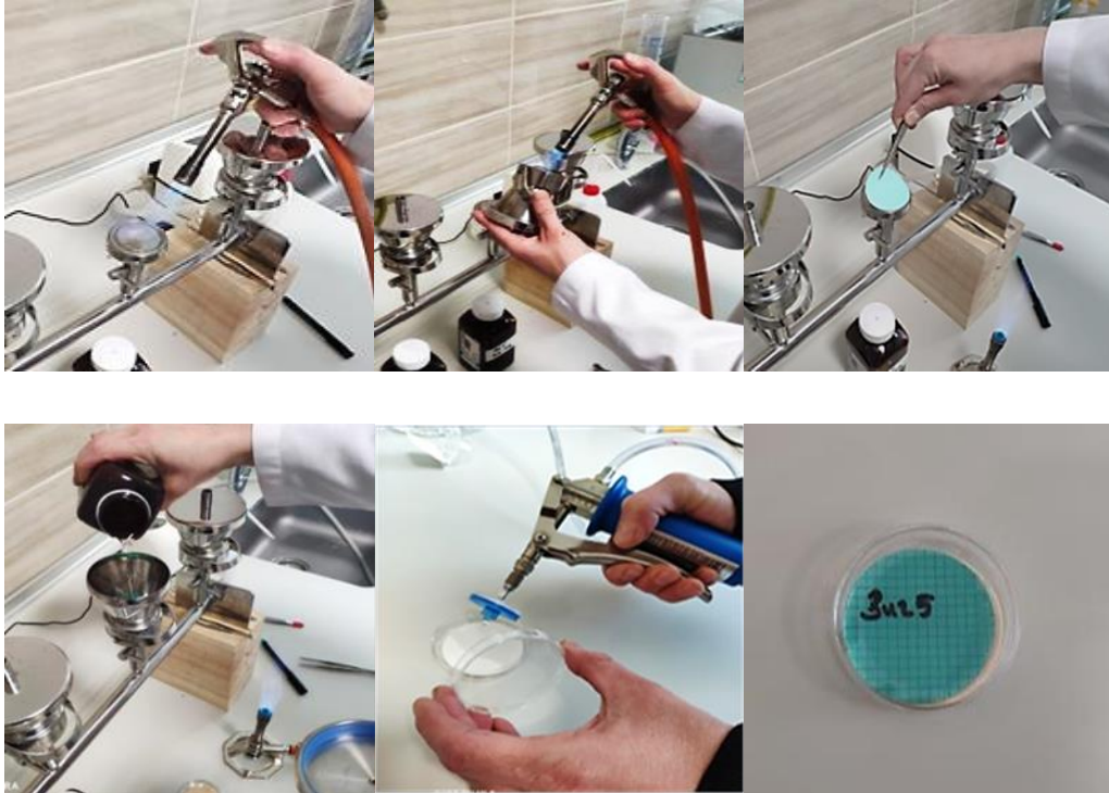
Şekil 3.4. Membran filtrasyon sisteminde çalışma aşamaları
